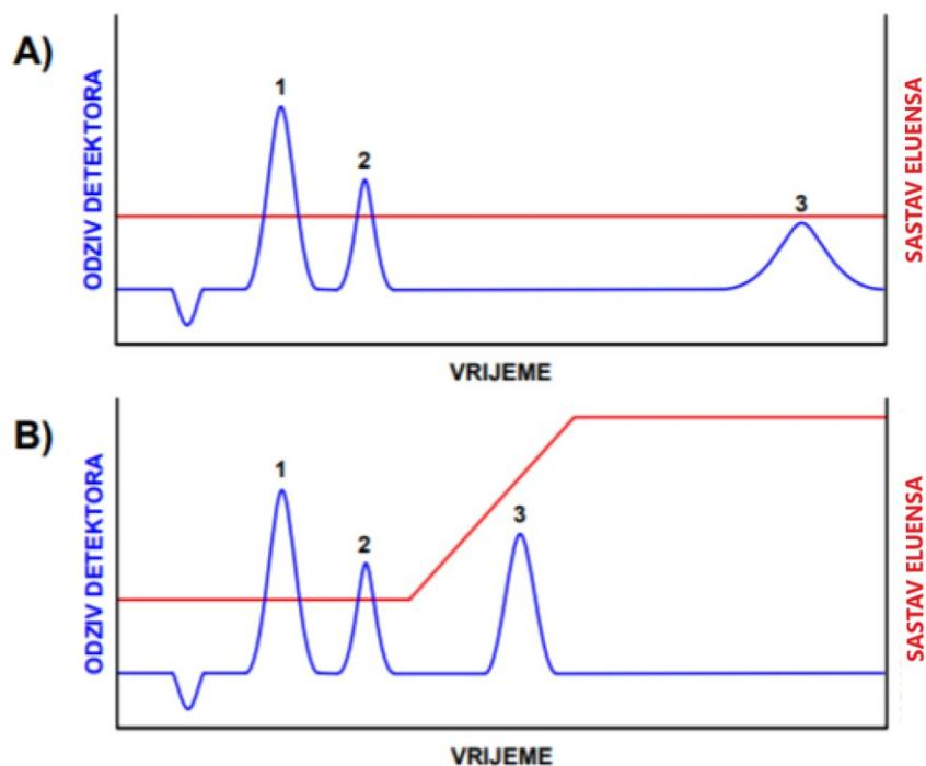
**Slika 11.** Shematski prikaz izokratnog (a) i gradijentnog eluiranja (b). Brojkama od 1 do 3 označena su tri analizirana sastojka iz uzorka.<sup>45</sup>
