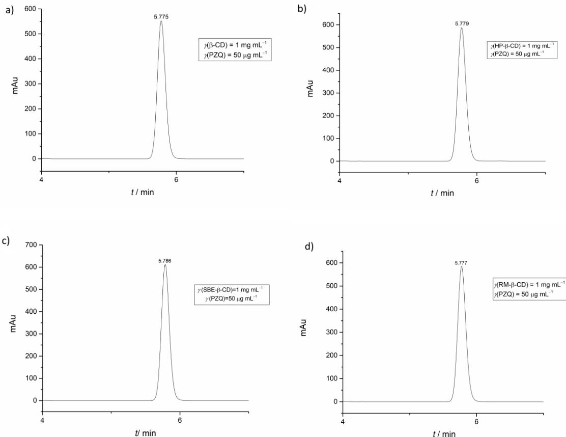
**Slika 13.** Kromatogrami prazikvantela u prisutnosti  $\beta$ -CD (a), HP- $\beta$ -CD (b), SBE- $\beta$ -CD (c) i RM- $\beta$ -CD (d) ( $\gamma(\text{PZQ}) = 50 \mu\text{g mL}^{-1}$ ;  $\gamma(\text{CD}) = 1 \text{ mg mL}^{-1}$ )
