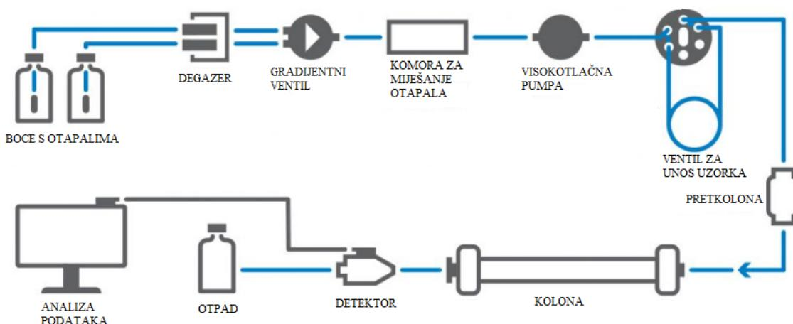
Slika 10. Shema HPLC uređaja<sup>42</sup>
