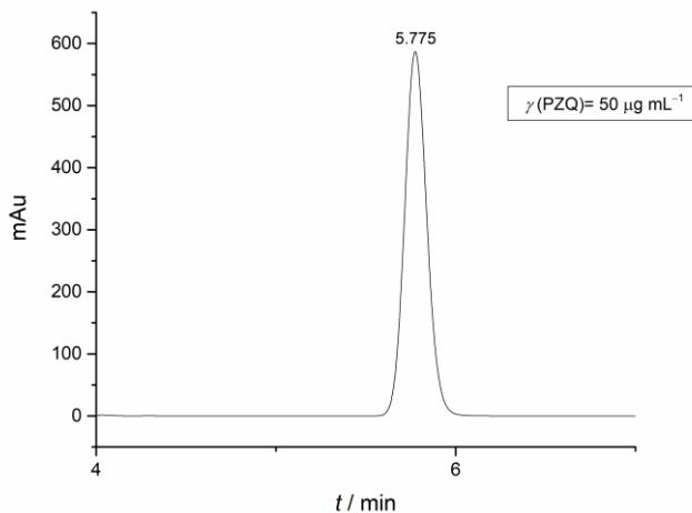
**Slika 12.** Kromatogram otopine prazikvantela koncentracije  $50 \mu\text{g mL}^{-1}$
