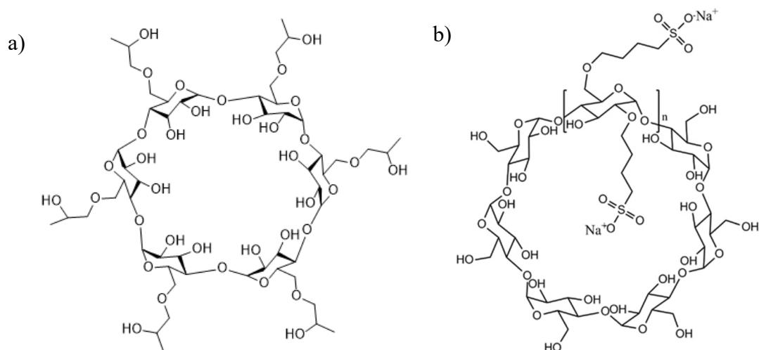
**Slika 6.** Struktura HP- $\beta$ -CD<sup>29</sup> (a) i SBE- $\beta$ -CD<sup>30</sup> (b)
