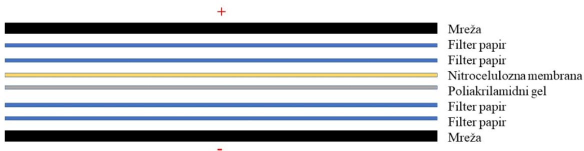
Slika 4. Način slaganja kazete za prijenos proteina.
