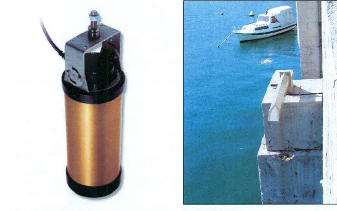
Slika 2.2: Radarski mareograf Kalesto (lijevo) i nosač unutar kojeg se nalazi uređaj postavljen u Bakru, slika preuzeta iz [9].
