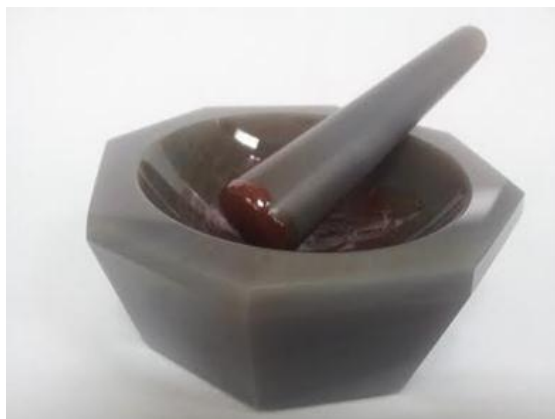
Slika 31. Crvenosmeđa smola dobivena ručnim suhim mljevenjem ov2an -a i 1,2-tfib -a u ahatnom tarioniku
