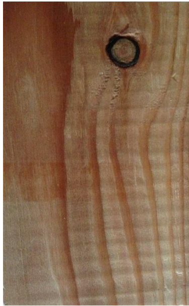
Slika 16. Tangentni presjek drva europskog ariša
