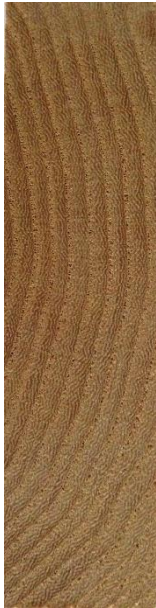
Slika 153. Poprečni presjek drva bijelog jasena
