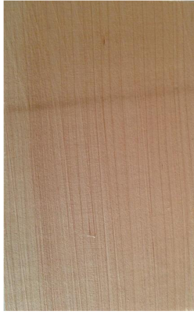
Slika 57. Tangentni presjek drva johe
