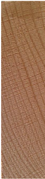
Slika 104. Poprečni presjek drva obične bukve
