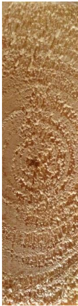
Slika 36. Poprečni presjek drva američkog borovca
