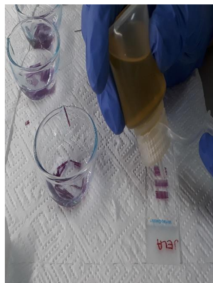
Slika 10. Prikaz uklapanja drvnih presjeka pomoću sintetskog medija Euparal
