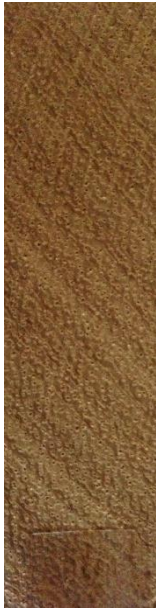
Slika 132. Poprečni presjek drva iroka
