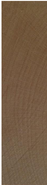
Slika 50. Poprečni presjek drva gorskog javora
