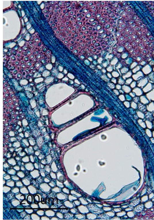
Slika 136. Poprečni presjek drva iroka, povećanje objektiva 10X
