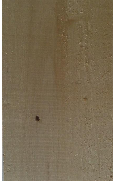
Slika 182. Tangentni presjek drva topole
