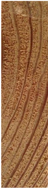
Slika 15. Poprečni presjek drva europskog ariša
