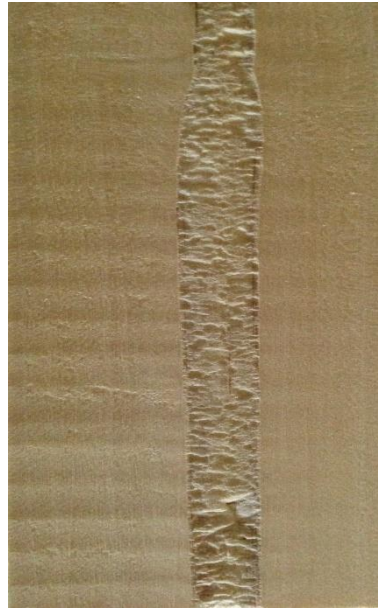
Slika 196. Tangentni presjek drva crne bazge
