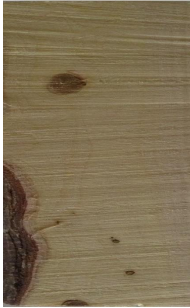
Slika 2. Tangentni presjek drva obične borovice
