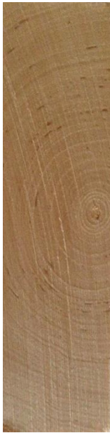
Slika 174. Poprečni presjek drva obične muginje
