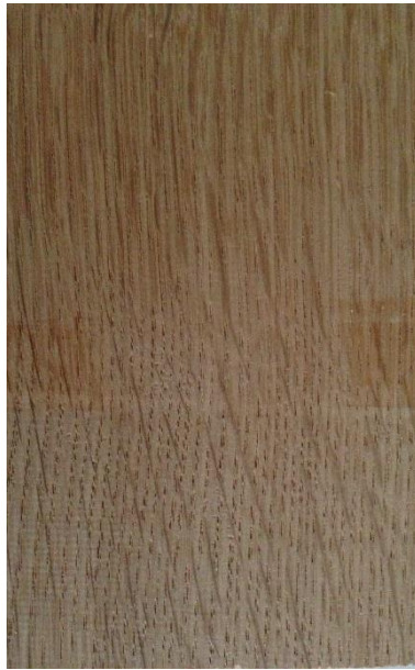
Slika 112. Tangentni presjek drva hrasta
