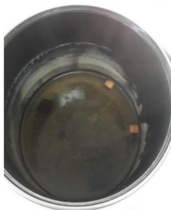
Slika 2. Prikaz omekšavanja drva kuhanjem u destiliranoj vodi
