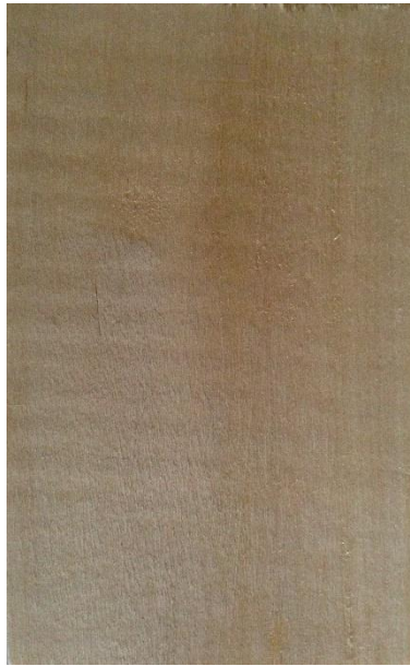
Slika 64. Tangentni presjek drva obične breze
