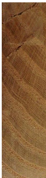
Slika 145. Poprečni presjek drva crnog duda
