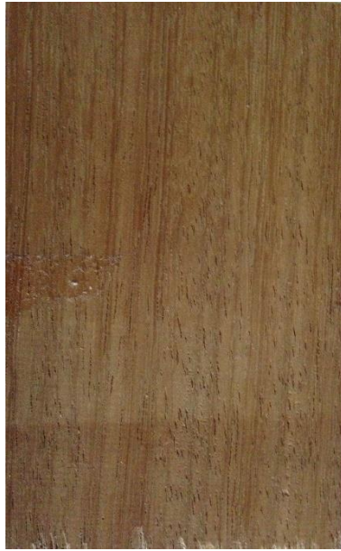
Slika 133. Tangentni presjek drva iroka
