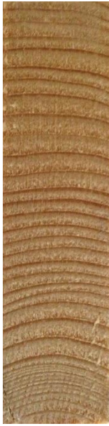
Slika 22. Poprečni presjek drva obične smreke
