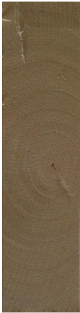
Slika 83. Poprečni presjek drva crnog graba
