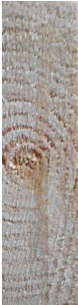
Slika 188. Poprečni presjek drva lipa
