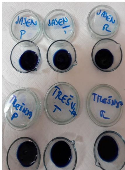
Slika 6. Prikaz bojenja presjeka drva
