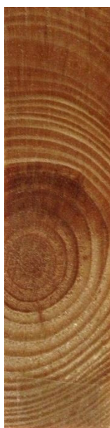
Slika 29. Poprečni presjek drva crnog bora
