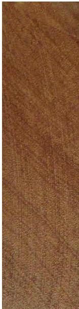
Slika 125. Poprečni presjek drva američkog mahagonija
