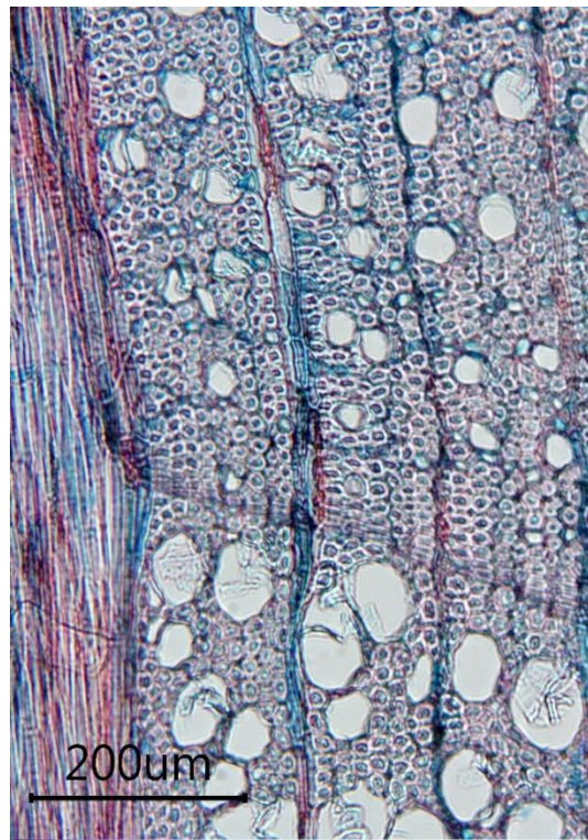
Slika 108. Poprečni presjek drva obične bukve, povećanje objektiva 10X
