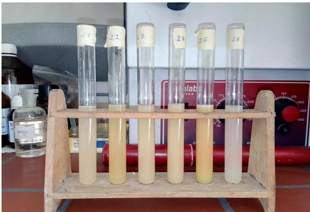
Slika 4. Laboratorijska analiza masenog udjela organske tvari u sedimentu.
