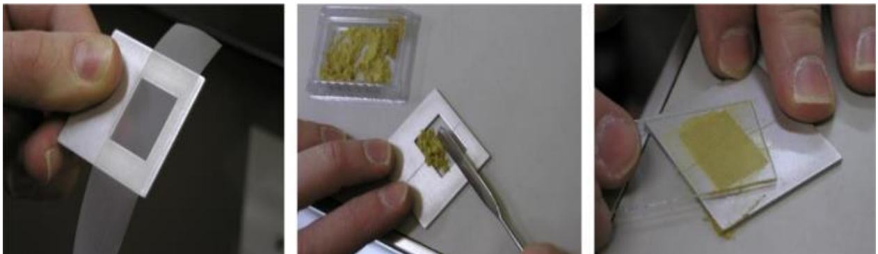
Slika 7. Postupak pripreme uzorka: a) postavljanje ljepljive trake na aluminijski nosač, b) nanošenje uzorka, c) zaravnjavanje uzorka predmetnim stakalacem.
