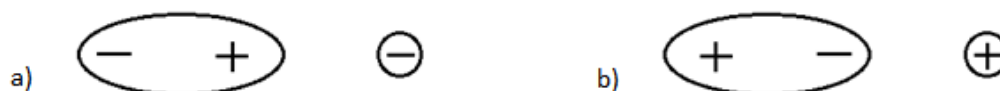
Slika 1.1. a) Orijentacija polarne molekule u električnom polju negativnog iona, b) orijentacija polarne molekule u električnom polju pozitivnog iona.
