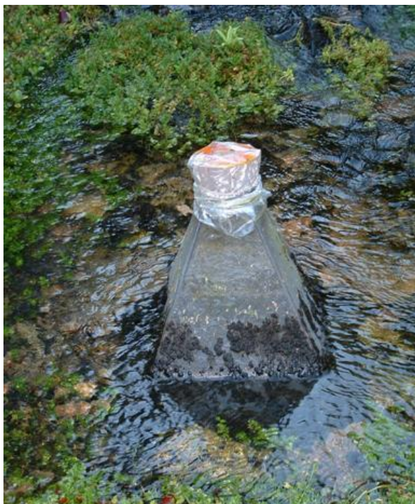
Slika 1.1. Emergencijska piramidalna klopka pričvršćena za supstrat (foto: M. Ivković).
