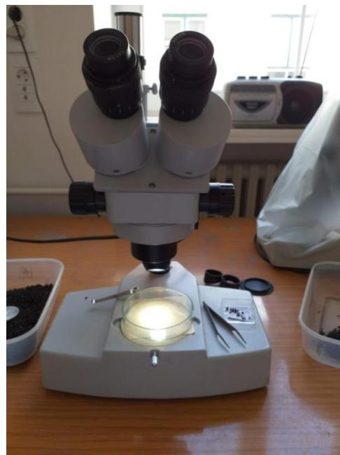
**Slika 3.** Binokularna lupa za izolaciju i determinaciju biljnih makrofosila
