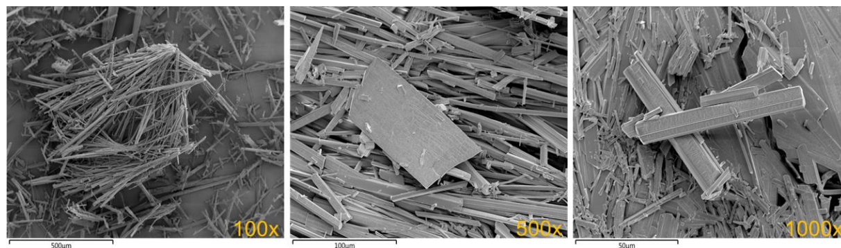
Slika D36. SEM prikaz uzorka dobivenog kristalizacijom reakcijske smjese dpzHCl i 14tfib u stehiometrijskom omjeru 2:5 iz otopine acetonitrila i etanola (1:1)
