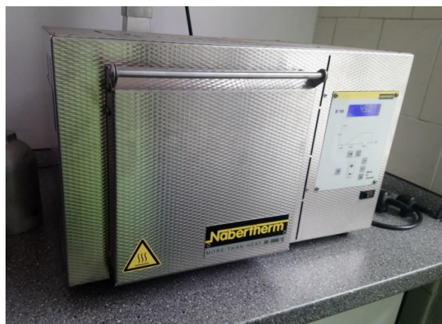
Slika 9. Žarenje uzoraka u mufalnoj peći pri 400°C
