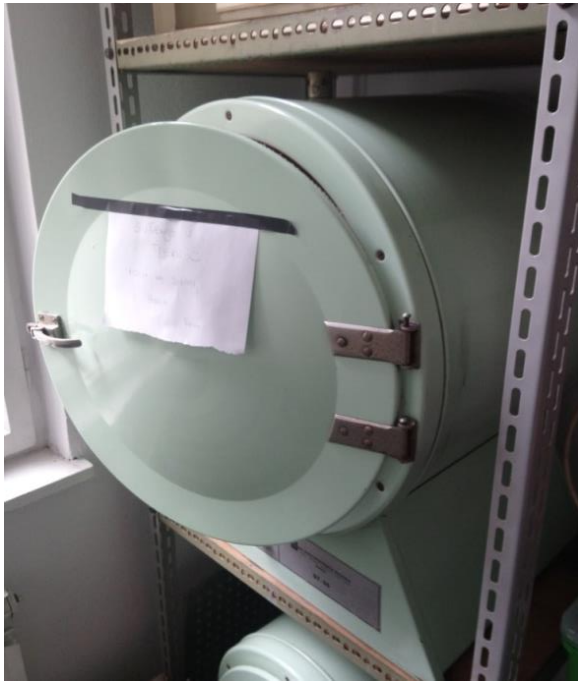
Slika 6. Sušenje uzoraka u sušioniku pri temperaturi 150 °C
