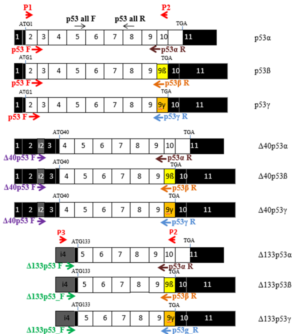
Slika 12. Položaj početnica u ugniježđenom qPCR-u za određivanje ekspresije izoformi gena TP53 . Za „duge“ izoforme u pre-amplifikacijskoj reakciji koristila sam početnice P1 i P2 (označene crvenom bojom). Nakon pre-amplifikacijske reakcije slijedio je qPCR za izoforme p53α, p53β, p53γ, Δ40p53α, Δ40p53β, Δ40p53γ. Za „kratke“ izoforme u pre-amplifikacijskoj reakciji koristila sam početnice P3 i P2 (označene crvenom bojom). Nakon pre-amplifikacijske reakcije slijedio je qPCR za Δ133p53α, Δ133p53β, Δ133p53γ.
