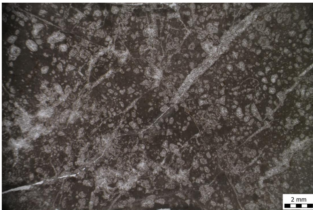
Slika 17: Packstone sa potpuno rekristaliziranim klastima. Preparat najvećim dijelom sadržava presjeke problematičnog roda Claracrusta (bijelo)
