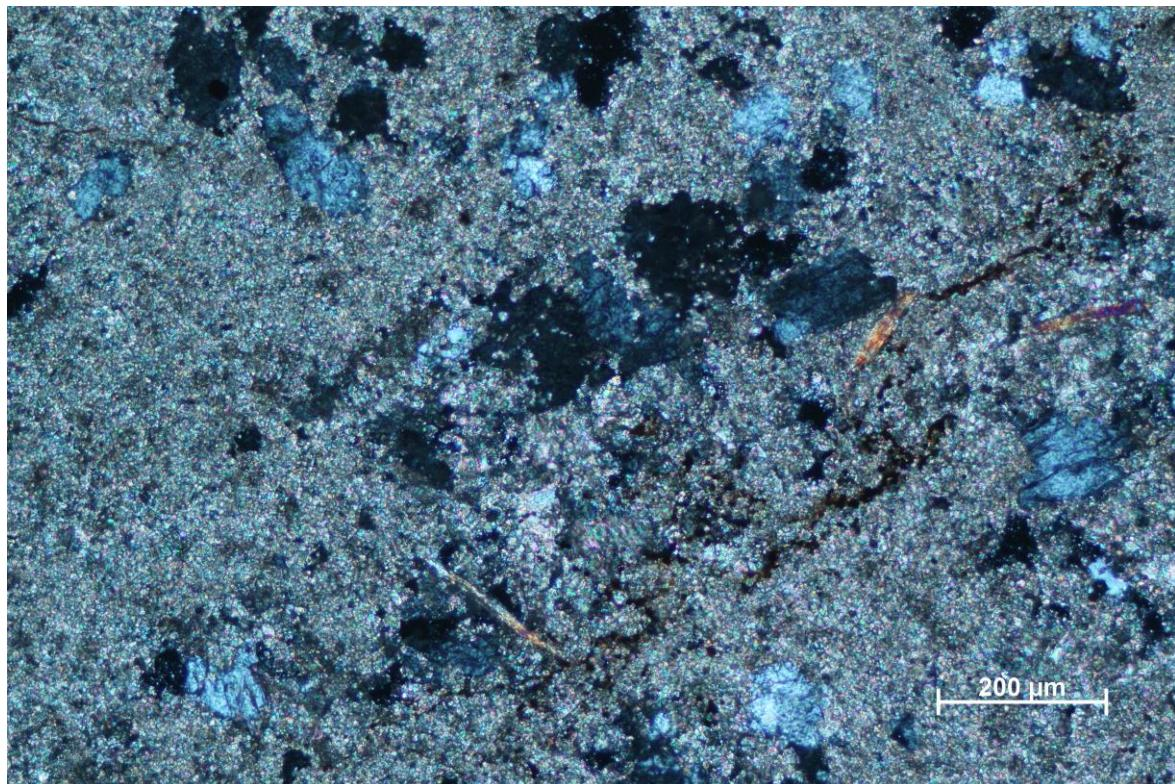
Slika 9. Štapići muskovita i zrna kremena u mikritnom vezivu (uzorak B11, zona 1). Uzorak snimljen s uključenim analizatorom na polarizacijskom mikroskopu na Mineraloško-petrografском заводу Геолошког одсјека PMF-a.
