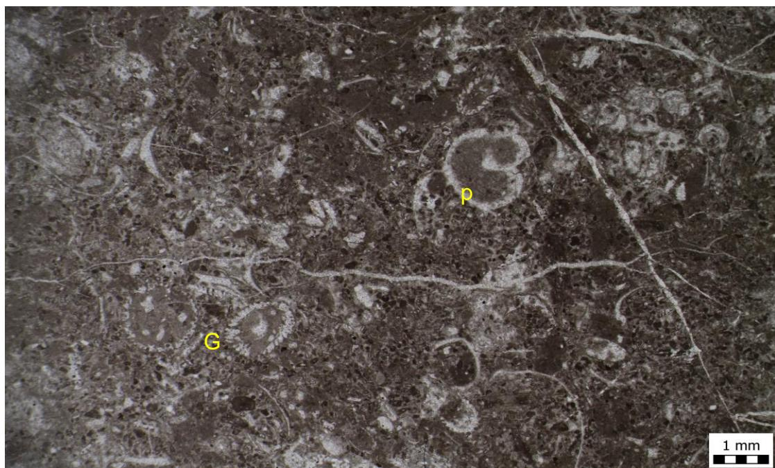
Slika 14: Karbonatni wackestone do packstone sa vidljivim primjercima crvenih algi iz skupine Gymnocodiaceae (oznaka G) (vjerojatno rod *Permocalculus*), presjekom puža (oznaka p) i ostalog fosilnog kršja povezanog mikritnim vezivom (uzorak B20, zona 3)
