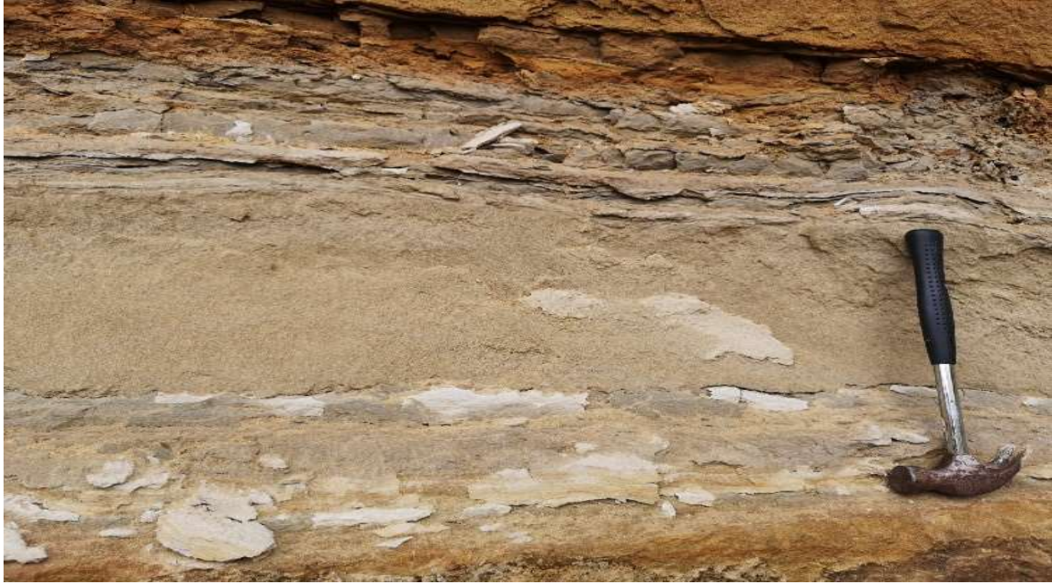
Slika 5.2 Masivni srednje sortirani pijesak (donji dio slike) i kalčitični silt (gornji dio slike) u pozajmištu pijeska kod Gornje Batine.
