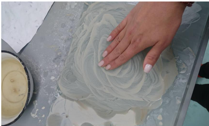
Slika 9. Poliranje uzorka pomoću abrazivnog korundovog praha u laboratoriju GPZ-a.
