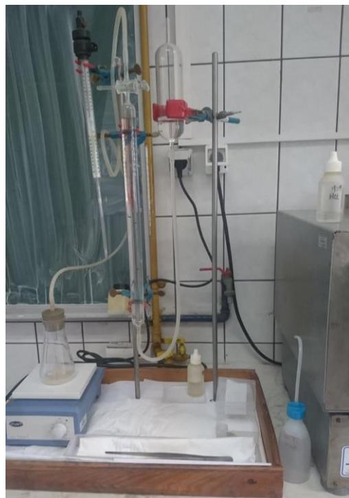
Slika 13. Scheiblerov kalcimetar u laboratoriju MPZ-a.
