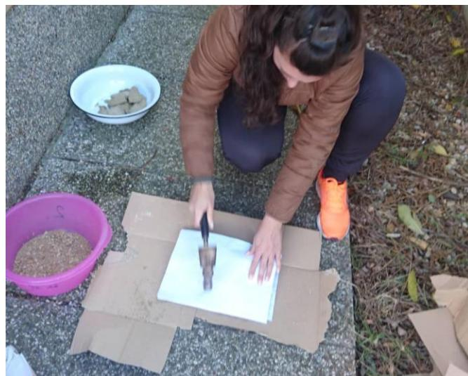
**Slika 10.** Usitnjavanje uzorka mehaničkim putem.
