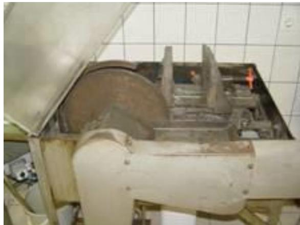
**Slika 8.** Pila za rezanje stijena u laboratoriju GPZ-a.
