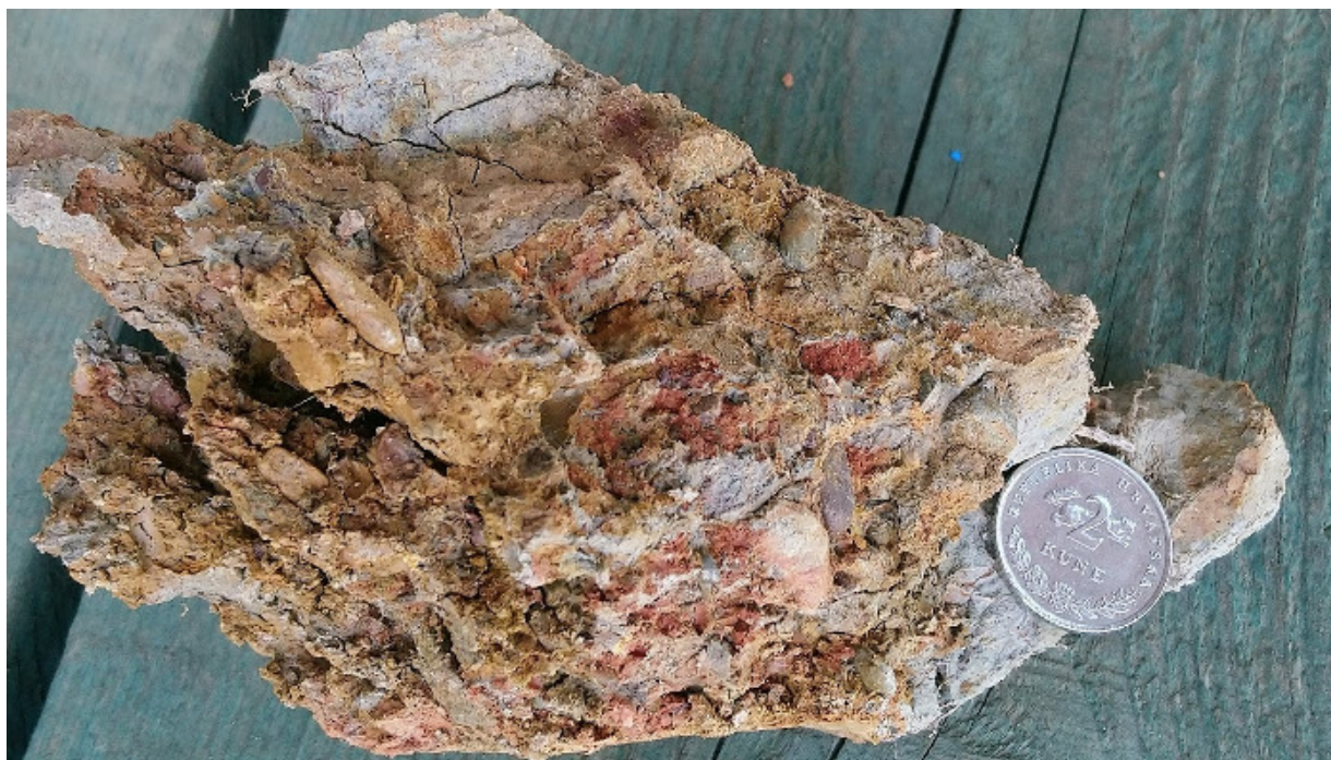
Slika 6.22. Konsolidirani uzorak sitnozrnatog konglomerata (MOR2)
