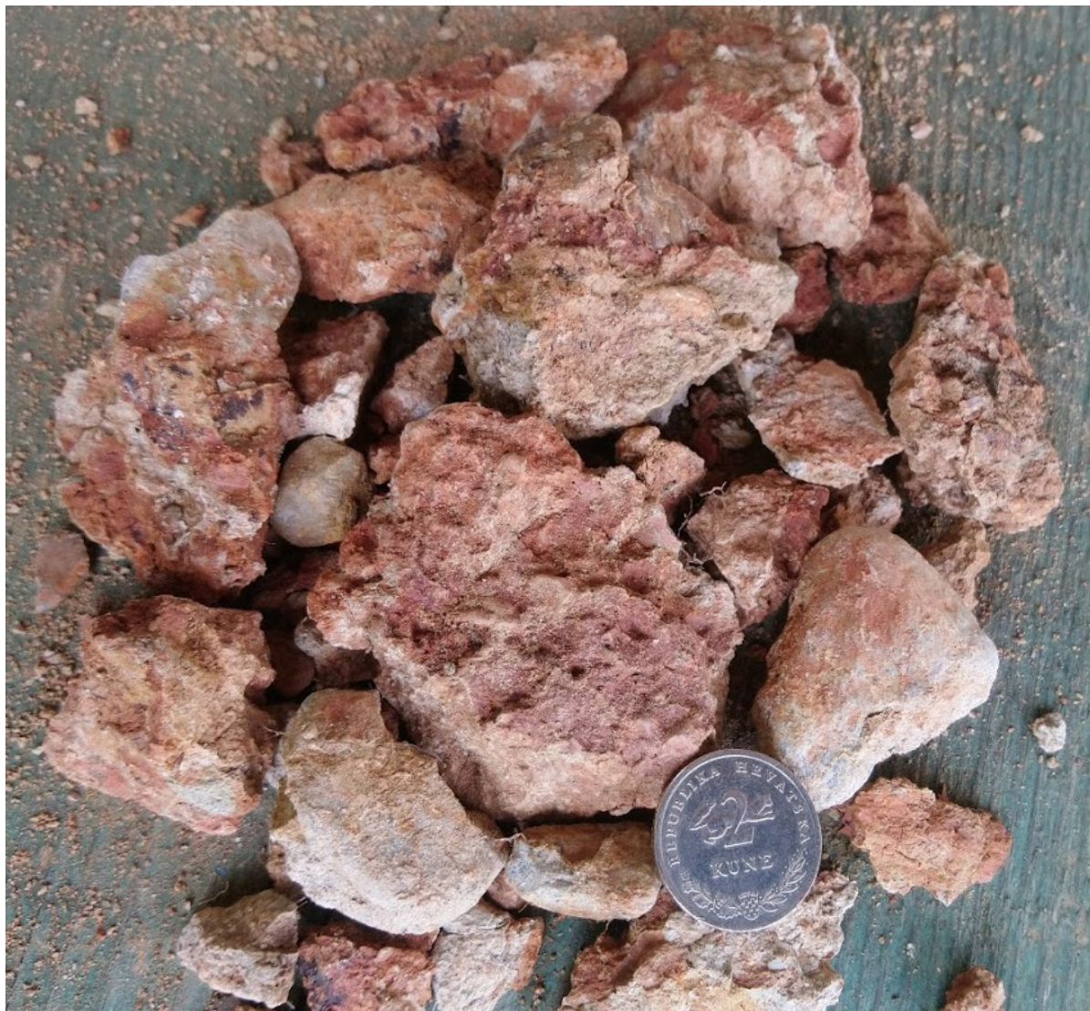
Slika 6.24. Rastresiti uzorak krupnozrnatog konglomerata (MOR3)
