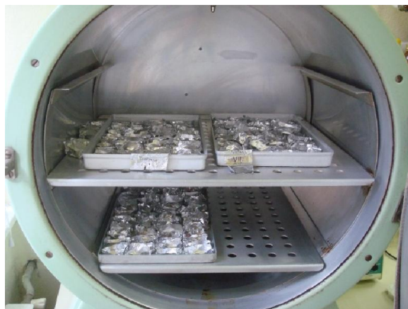
Slika 10. Termostat s lađicama u kojima se na 80 °C suše izolirani organi juvenilnih rakova.
