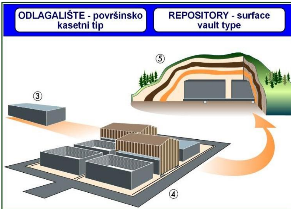
Slika 3. Polaganje betonskih spremnika ispod površine Izvor: Odlaganje NSRAO-a , n.d.
