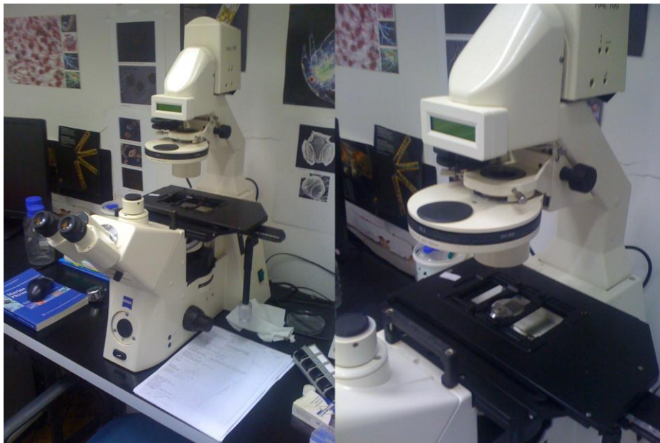
Slika 22. Inverzni mikroskop AxioVert 200, Zeiss GmbH
