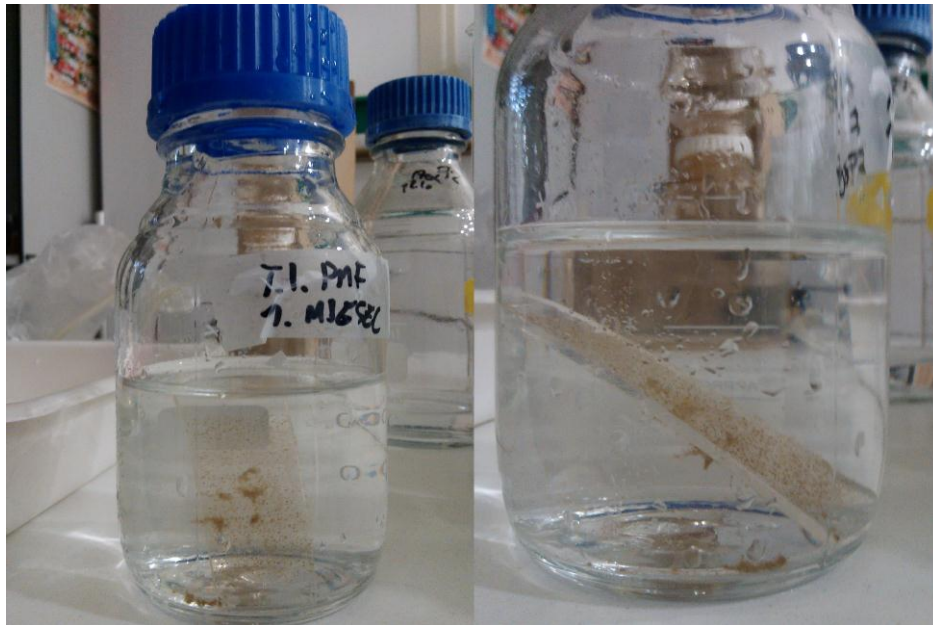
Slika 15. Schott boce sa pleksiglas pločicama i fiziološkom otopinom
