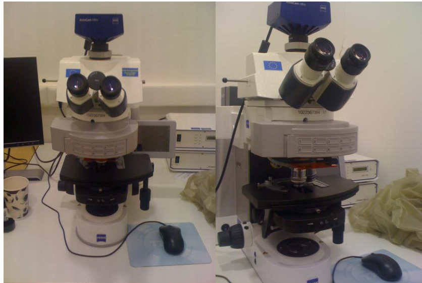
Slika 18. Epifluorescencijski mikroskop Zeiss AxioCam HRm
