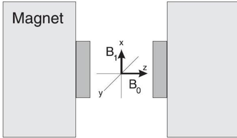
Slika 1.3. Smjerovi magnetskih polja  $\vec{B}_0$  i  $\vec{B}_1$  u rotirajućem sustavu.
