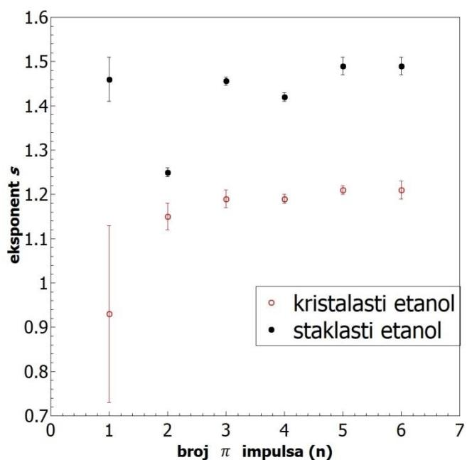
Slika 6.8 a) Vrijeme relaksacije fazne memorije  $T_m$  i b) eksponent  $s$  izmjereni pri 20 K za TEMPO ugrađen u staklasti i kristalasti etanol u ovisnosti o broju  $\pi$  impulsa u CPMG-CT eksperimentu. Primijenjen je izraz (5.2) za modeliranje eksperimentalnih podataka. Linije (crna za staklasti, crvena za kristalasti etanol) predstavljaju najbolju prilagodbu relacije (6.1) na eksperimentalne podatke uz dobivene parametre prikazane u tablici 2.
