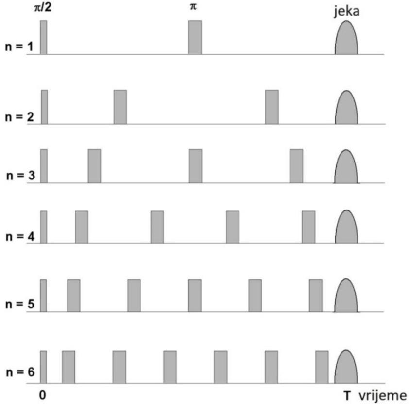
Slika 5.10. Protokol dinamičkog rasprezanja baziran na CPMG-CT impulsnom slijedu [93]. U  $t = T$  detektira se signal spinske jeke neovisno o broju  $n = 1, \dots, 6$  primjenjenih  $\pi$  impulsa.
