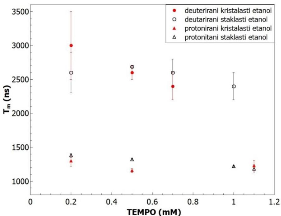
Slika 6.5. Vrijeme relaksacije fazne memorije  $T_m$  izmjereno pri 80 K kao funkcija koncentracije nitroksilnog radikala TEMPO ugrađenog u protonirani i deuterirani etanol u staklastom i kristalastom stanju.
