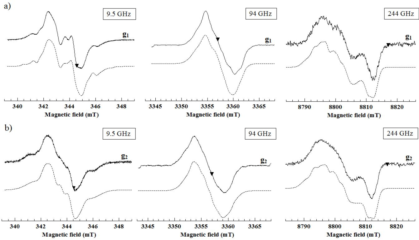
Slika 6.9 Usporedba eksperimentalnih i simuliranih ESR spektara staklastih uzoraka trehaloze  $g_1$  i  $g_2$  ozračenih dozom od 10 kGy pri ESR frekvencijama 9.5 GHz, 94 GHz i 244 GHz i sobnoj temperaturi [84]. Referentna  $g$ -vrijednost  $g = 2.00101$  označena je simbolom trokuta. Uzorak  $g_2$ , za razliku od uzorka  $g_1$ , dodatno je napuštan na  $T = 363$  K dva sata.
