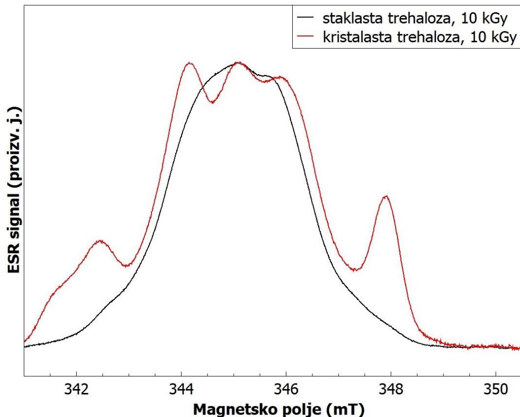
Slika E1 Signal elektronske spinske jeke paramagnetskih centara induciranih u polimorfima trehaloze snimljen pri 40 K kao funkcija magnetskog polja, FSE. Staklasta i kristalasta trehaliza ozračene su dozom od 10 kGy. ESR mjerena su pri frekvenciji od 9.5 GHz.
