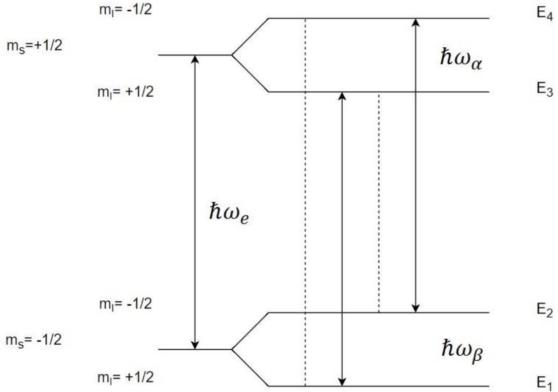
Slika 5.11. Dijagram energetskih razina za spinski sustav  $S = \frac{1}{2}, I = \frac{1}{2}$ . Energetskim razinama su pridruženi pripadni elektronski i nuklearni spinski kvantni brojevi  $m_s$  i  $m_I$ . Punim linijama su označeni dozvoljeni spinski prijelazi, a isprekidanim linijama zabranjeni spinski prijelazi.
