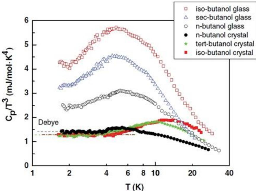
Slika 2.3. Ovisnost reduciranih toplinskih kapaciteta  $C_p/T^3$  o temperaturi za staklaste i kristalaste izomere alkohola butanola [53]. Toplinski je kapacitet skaliran na Debyevu temperaturnu ovisnost.
