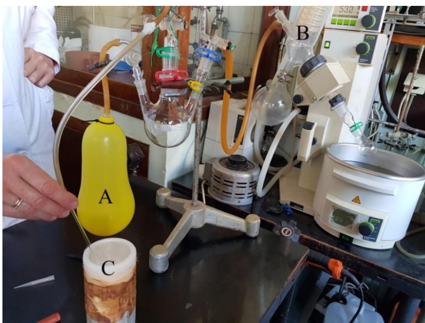
Slika 5.4. Proces deoksigenacije, tj. izmjene kisika argonom, u kapljevini etanola. Označeni su dijelovi aparature: A) balon ispunjen argonom, B) linija za evakuiranje, C) spremnik s tekućim dušikom.
