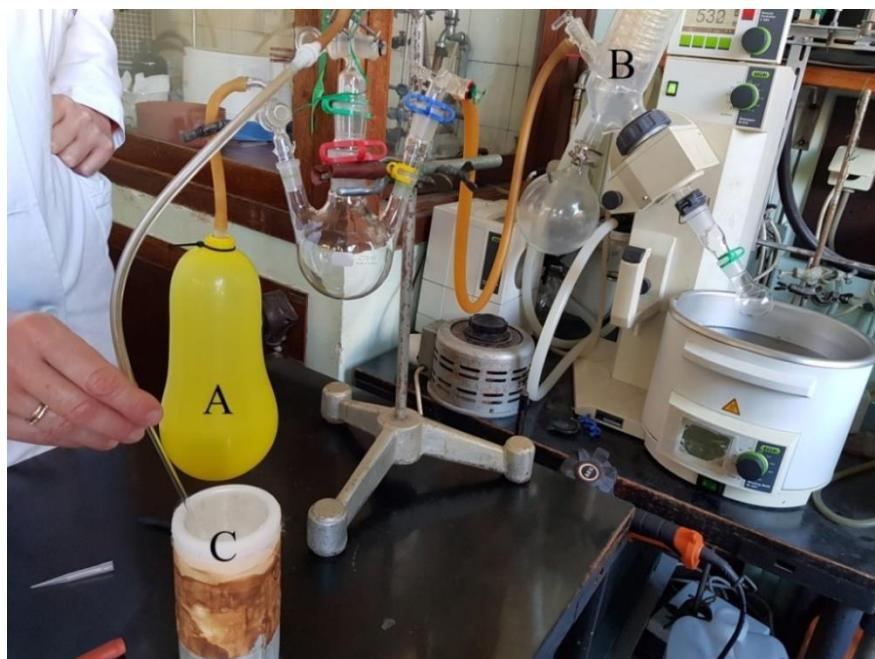
Slika 5.4. Proces deoksigenacije, tj. izmjene kisika argonom, u kapljevini etanola. Označeni su dijelovi aparature: A) balon ispunjen argonom, B) linija za evakuiranje, C) spremnik s tekućim dušikom.
