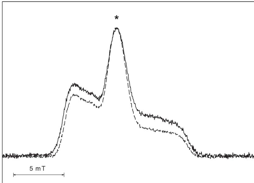
Slika 6.1 Signal elektronske spinske jeke, FSE, nitroksilnog radikala TEMPO ugrađenog u kristalasti (puna linija) i staklasti etanol (iscrtkana linija) snimljen pri 80 K kao funkcija magnetskog polja. Simbol označava centralnu spektralnu poziciju pri kojoj su izvršena sva mjerenja vremena relaksacije fazne memorije. Prikazani podaci su normalizirani na vrijednost centralne pozicije spektara [69].
