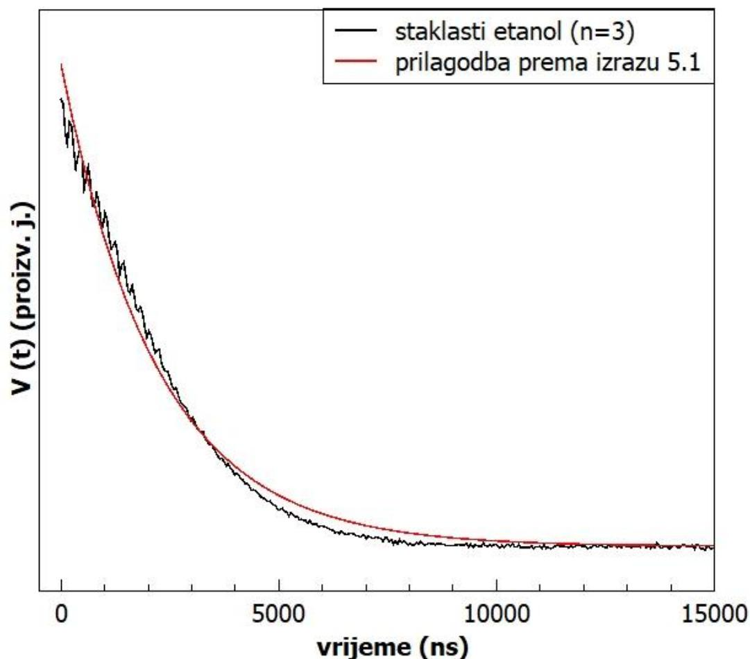
Slika B1 Vremensko trajanje signala spinske jeke nitroskilnog radikala TEMPO ugrađenog u staklasti etanol za CPMG-CT eksperiment u slučaju 3 primjenjena impulsa ( $n = 3$ ) pri 20 K . Crvena linija označava prilagodbu prema izrazu 5.1.
