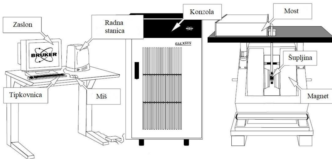
Slika 5.8 Shematski prikaz Bruker ELEXSYS 580 spektrometra [85].
