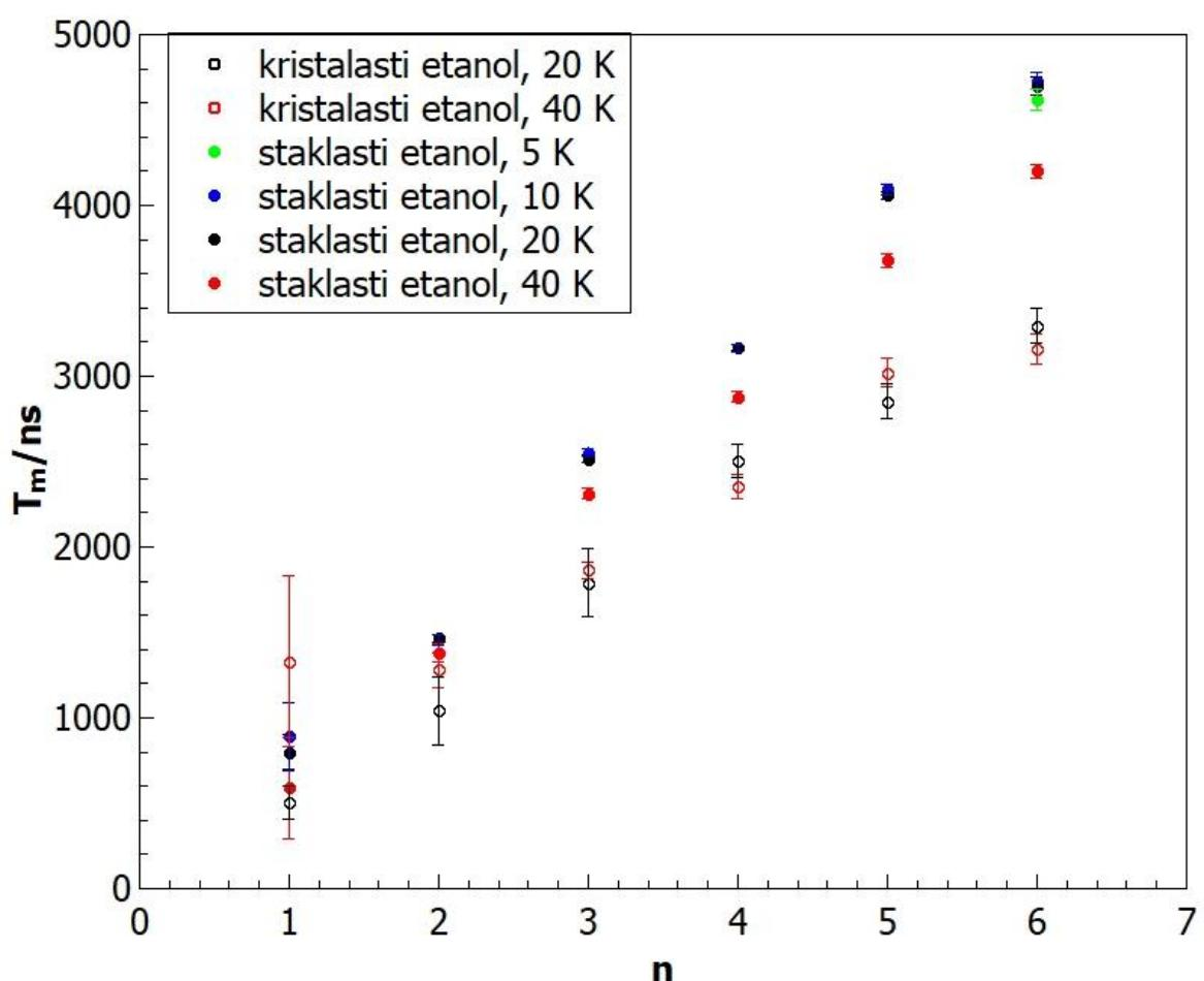
Slika C4 Vrijeme relaksacije fazne memorije  $T_m$  nitroksilnog radikala TEMPO ugrađenog u staklastom i kristalastom etanolu dobiveno pri različitim temperaturama u CPMG-CT eksperimentima prema izrazu (5.2).
