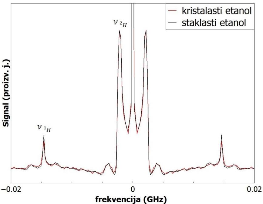
Slika 6.4. (a) Vremenska i (b) frekventna domena 3P\_ESEEM eksperimenta pri 40 K. Deuterirani nitroksilni radikal TEMPO ugrađen je u protonirani staklasti i kristalasti etanol. Označeni su doprinosi protonske frekvencije  $\nu_{1H}$  i deuteronske frekvencije  $\nu_{2H}$ .
