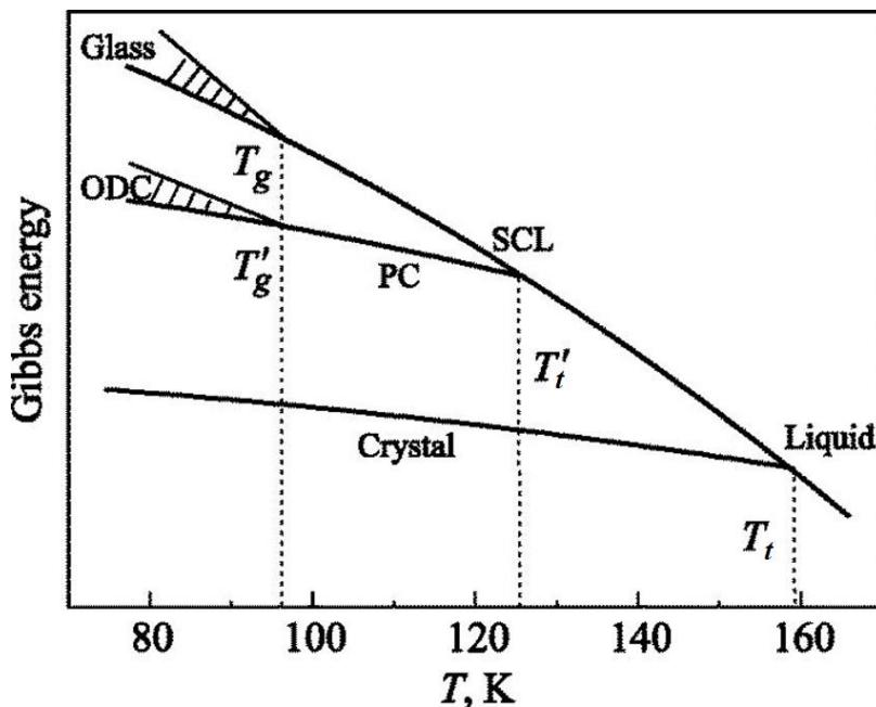
Slika 4.1. Shematski prikaz faznog dijagrama za etanol [67]. Hlađenjem kapljevine etanola nastaju faze: pothlađena kapljevina (SLC), plastični kristal (PC), orijentacijski neuređen kristal (ODC), strukturno staklo i uređena kristalasta faza.
