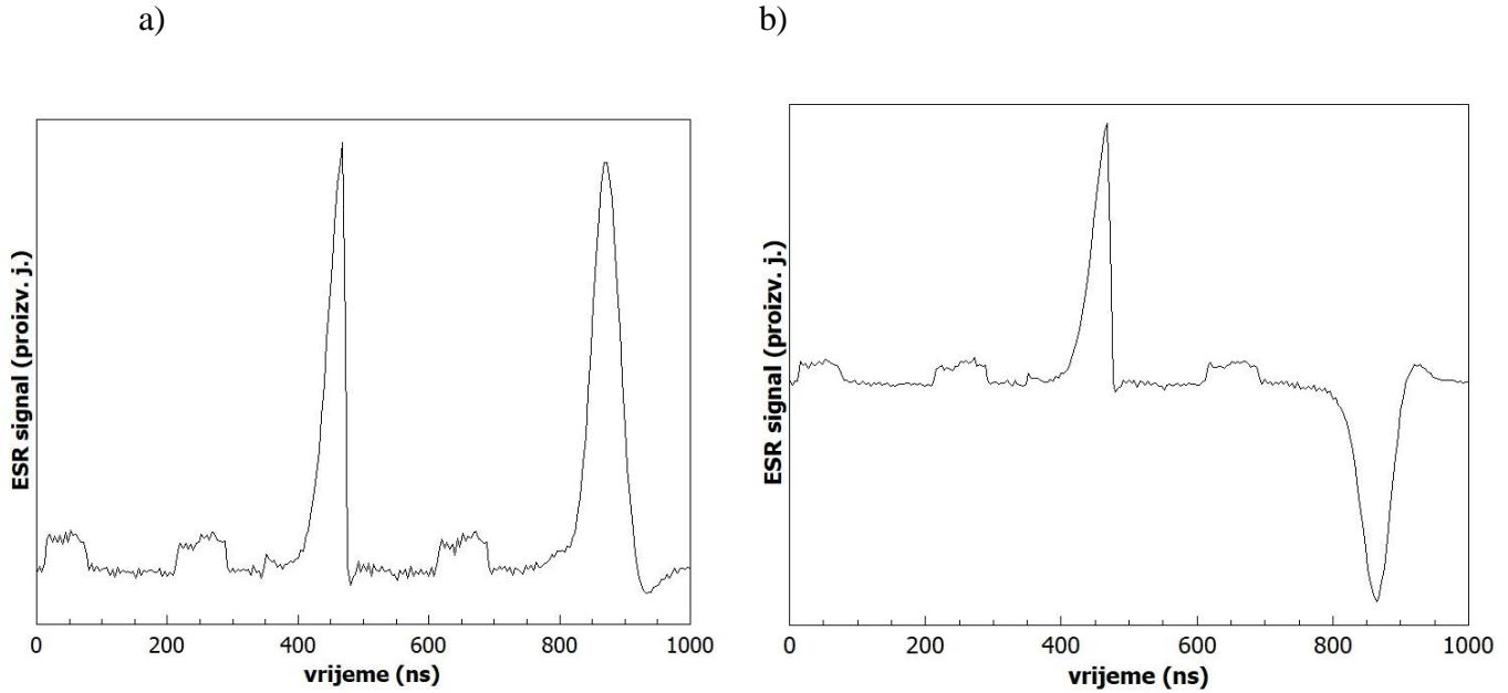
Slika A.2 Eksperimentalni prikaz djelovanja impulsnog slijeda: a)  $\frac{\pi}{2} \left|_x - \tau - \pi \right|_y - 2\tau - \pi \left|_y - \tau$ , b)  $\frac{\pi}{2} \left|_x - \tau - \pi \right|_y - 2\tau - \pi \left|_x - \tau$  na sustav elektronskih spinova koji vodi do detekcije maksimalnog signala u vremenu  $t = \tau$  nakon posljednjeg impulsa u slijedu.
