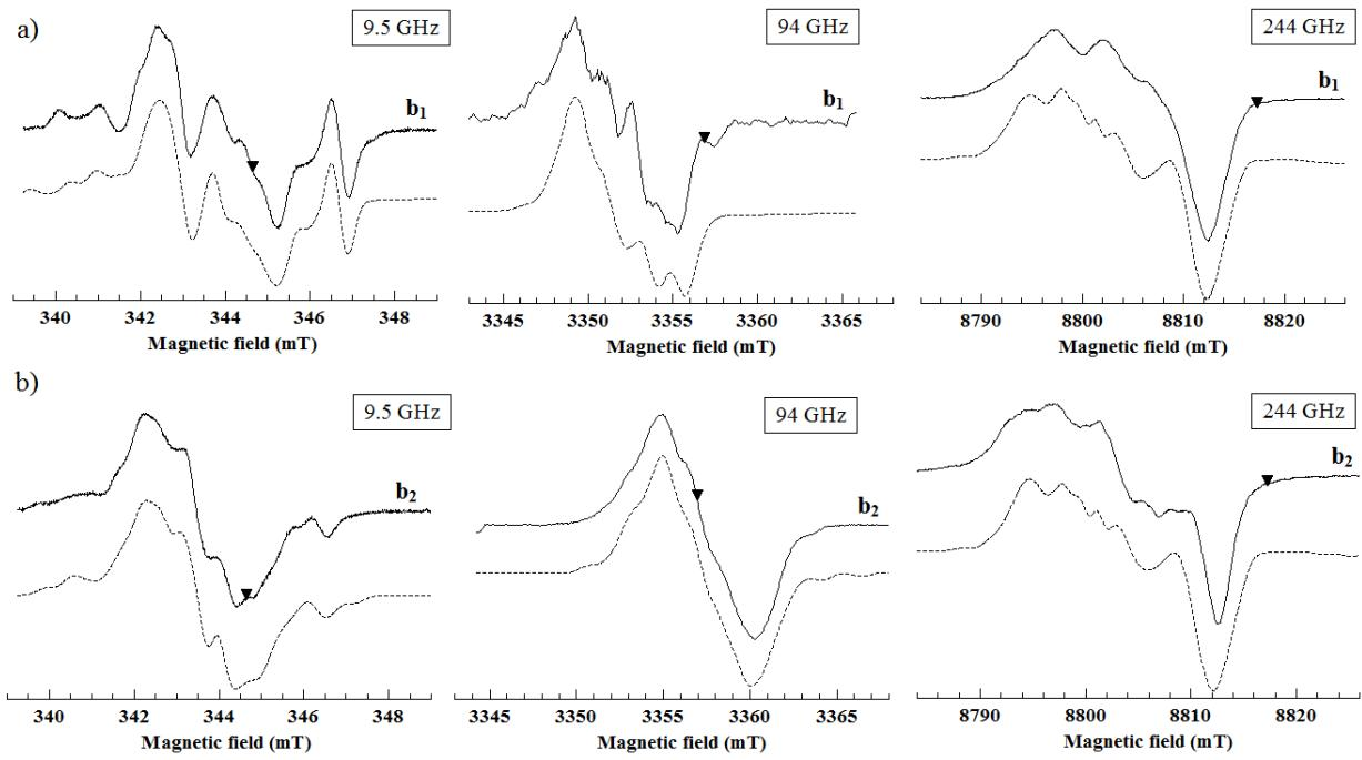
Slika 6.10 Usporedba eksperimentalnih i simuliranih ESR spektara kristalastih uzoraka trehaloze  $b_1$  i  $b_2$  ozračenih dozom od 10 kGy pri ESR frekvencijama 9.5 GHz, 94 GHz i 244 GHz i sobnoj temperaturi [84]. Referentna g-vrijednost  $g = 2.00101$  označena je simbolom trokuta. Uzorak  $b_2$ , za razliku od uzorka  $b_1$ , dodatno je napuštan na  $T = 363$  K tijekom 17 sati.
