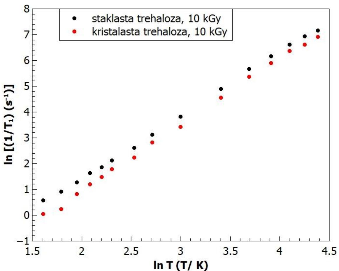
Slika E2 Ovisnost brzine spin-rešetka relaksacije  $\frac{1}{T_1}$  o temperaturi za paramagnetske centre inducirane u staklastoj i kristalastoj trehalazi u temperaturnom intervalu od 5-80 K [10].
