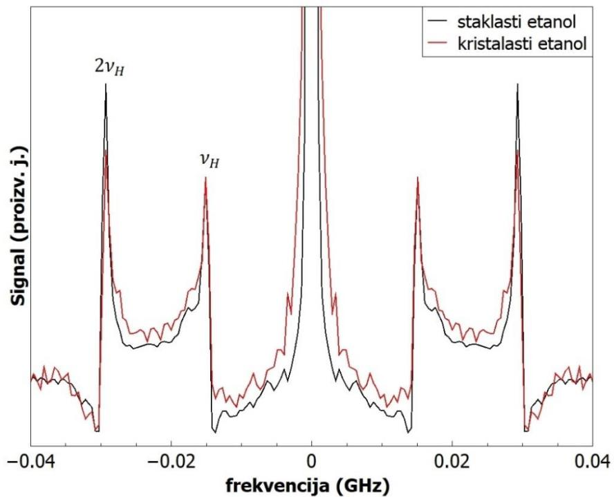
Slika 6.2. (a) Vremenska i (b) frekventna domena 2P\_ESEEM eksperimenta pri 40 K. Nitroksilni radikal TEMPO ugrađen je u staklasti i kristalasti etanol. Označeni su doprinosi protonske frekvencije  $\nu_H$  i njezinog prvog harmonika  $2\nu_H$ .
