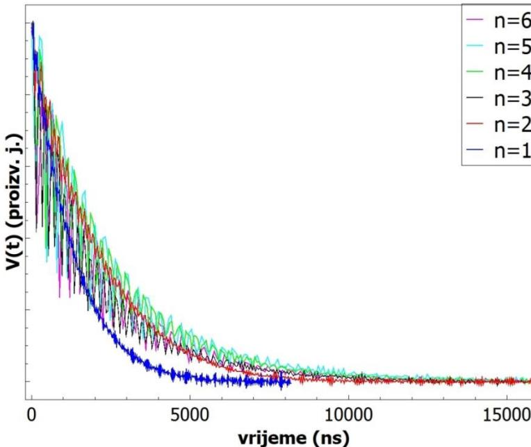
Slika 6.14 Vremenska ovisnost signala elektronske spinske jeke izmjerena pri 20 K CPMG-CT impulsnim slijedom za staklastu trehalozu ozračenu dozom od (a) 5 kGy i (b) 10 kGy.  $n = 1, \dots, 6$  označava broj primijenjenih  $\pi$  impulsa.
