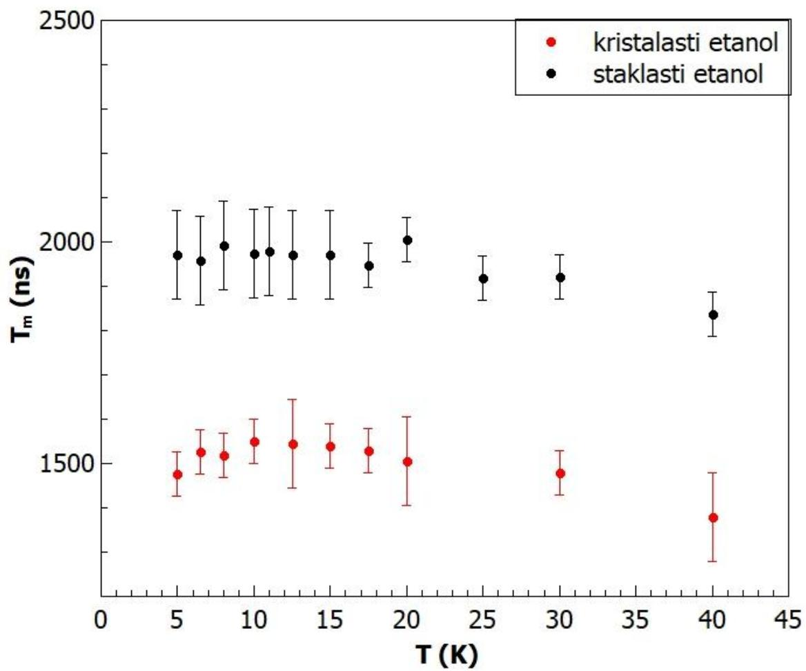
Slika C2 Temperaturna ovisnost vremena relaksacije fazne memorije  $T_m$  deuteriranog nitroksilnog radikala TEMPO u staklastom i kristalastom etanolu dobivena u eksperimentima Hahnove spinske jeke prema izrazu (5.2).
