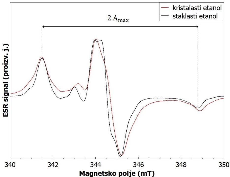
Slika 5.5 CW-ESR spektri staklastog i kristalastog etanola dopirani niktroksilnim radikalom TEMPO snimljeni na 80 K. Maksimalno hiperfini cijepanje označeno je kao  $2A_{\max}$ .
