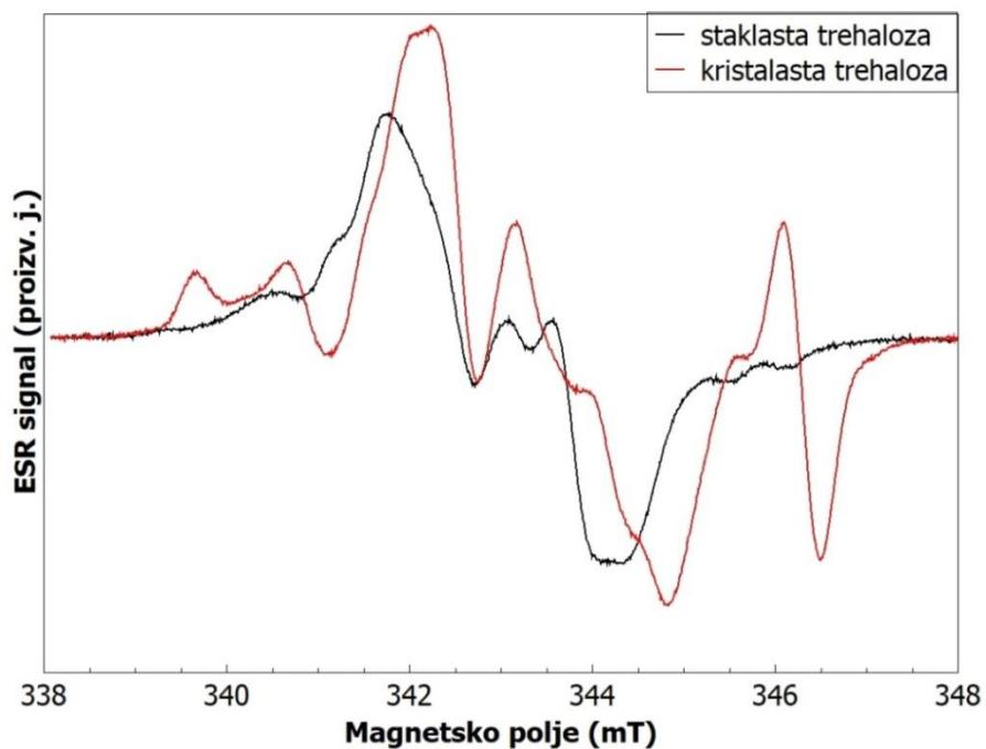
Slika 5.7. CW-ESR spektri staklaste i kristalaste trehaloze ozračene ionizirajućim  $\gamma$ -zračenjem doze od (a) 5 kGy, (b) 10 kGy snimljeni na sobnoj temperaturi.
