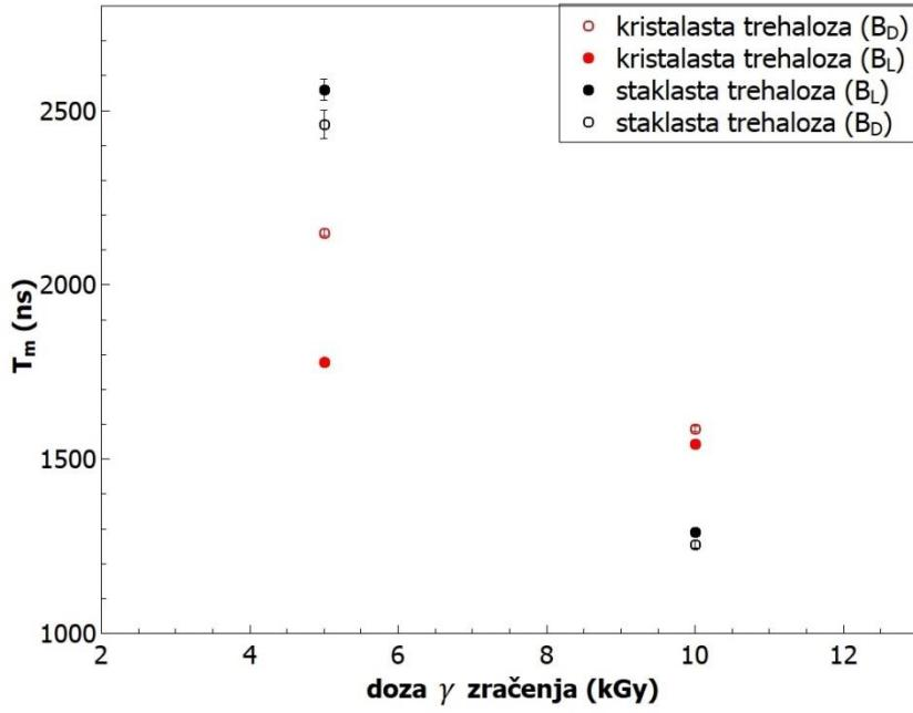
Slika 6.16 Ovisnost o dozi zračenja vremena relaksacije fazne memorije paramagnetskih centara induciranih u staklastoj i kristalastoj trehalozi. Prikazani su podaci za CPMG-CT eksperiment,  $n = 1$  (Tablica 1.), pri 20 K. Puni (prazni) simboli označavaju pozicije magnetskog polja  $B_L$ ( $B_D$ ) spektralne linije eksperimenta za provedene eksperimente prema slici 6.13.
