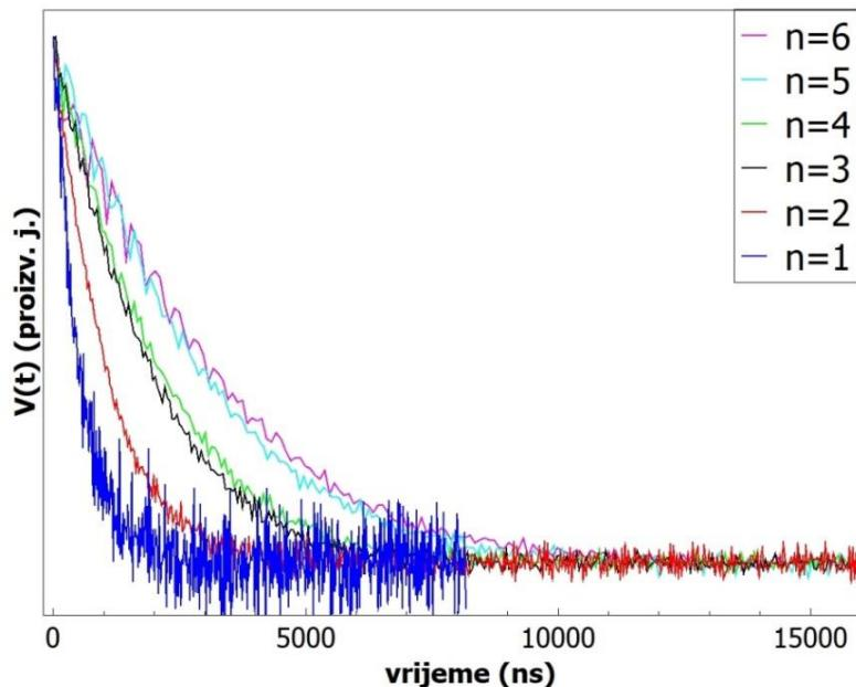
Slika 6.7. Vremenska ovisnost signala elektronske spinske jeke izmjerena CPMG-CT impulsnim slijedom za TEMPO ugrađen u (a) staklasti i (b) kristalasti etanol pri 20 K. Broj primijenjenih  $\pi$  impulsa prema slici 5.10 označen je kao  $n = 1, \dots, 6$
