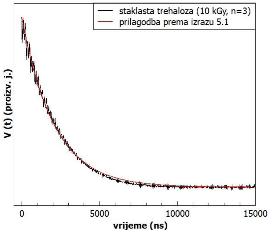
Slika F1 Vremensko trajanje signala spinske jeke paramagnetskih radikala induciranih  $\gamma$ -zračenjem doze 10 kGy u uzorku staklaste trehaloze za CPMG-CT eksperiment u slučaju 3 primjenjena impulsa ( $n = 3$ ) pri 20 K. Crvena linija označava prilagodbu prema izrazu 5.1.
