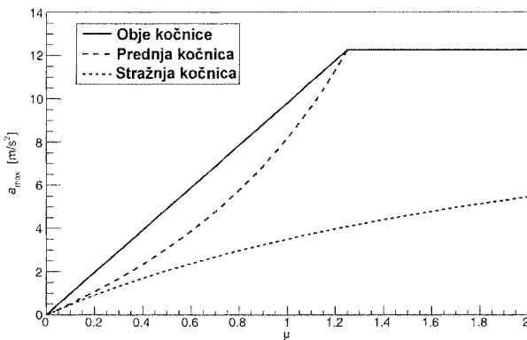
Slika 2. Maksimalno usporene pri kočenju stražnjom, prednjom te objema kočnicama u ovisnosti o jednakom koeficijentu trenja obiju guma ( $\mu_1 = \mu_2 = \mu$ ).  $L = 1.5 \text{ m}$ ;  $H = 0.6 \text{ m}$ ;  $x = 0.5$ ;  $g = 9.81 \text{ m/s}^2$ . Završni plato predstavlja globani maksimum usporene koji iznosi  $gxL/H = 12.26 \text{ m/s}^2$ . Istoj vrijednosti asimptotski teži i usporene samo stražnjom kočnicom, kao što je pokazano u (12).
