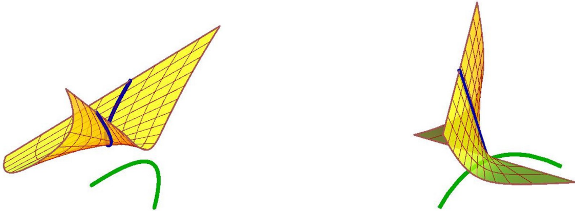
Slika 4.10: B -namotajna ploha (4.48) (lijevo) i (4.49) (desno) s baznom krivuljom (plava) i njena harmonijska evoluta (4.47) (zeleni)
