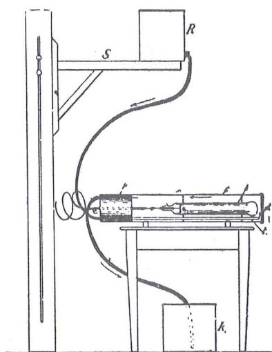
Slika 10. Teslina vakuumnska cijev s jednom elektrodom.
