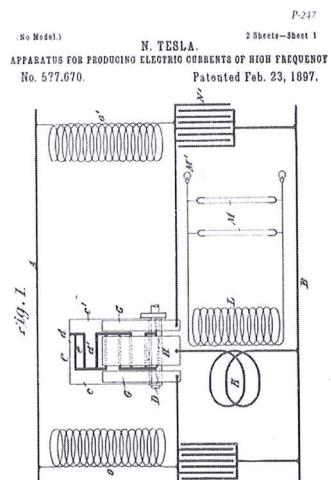
Slika 5. Uredaj za proizvodnju električne struje visoke frekvencije, patent br. 577670.
