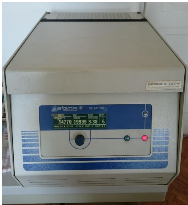
Slika 13. Visokookretajna centrifuga Sigma 3K18.
