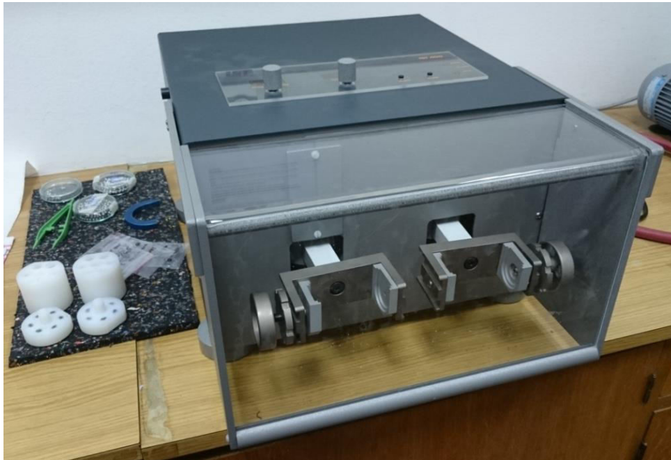
Slika 12. Homogenizator mlin IST 400.
