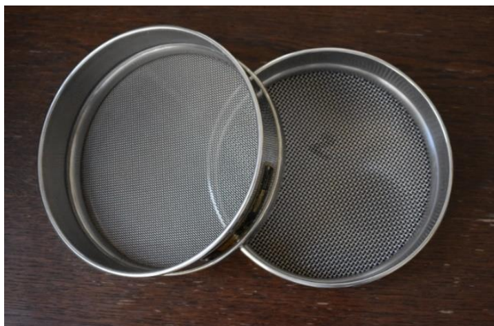
Slika 11. Sita promjera oka 2.5 i 1.0 mm, korištena u laboratorijskoj obradi uzoraka prikupljenih na lokalitetu Kalnik-Igrišće
