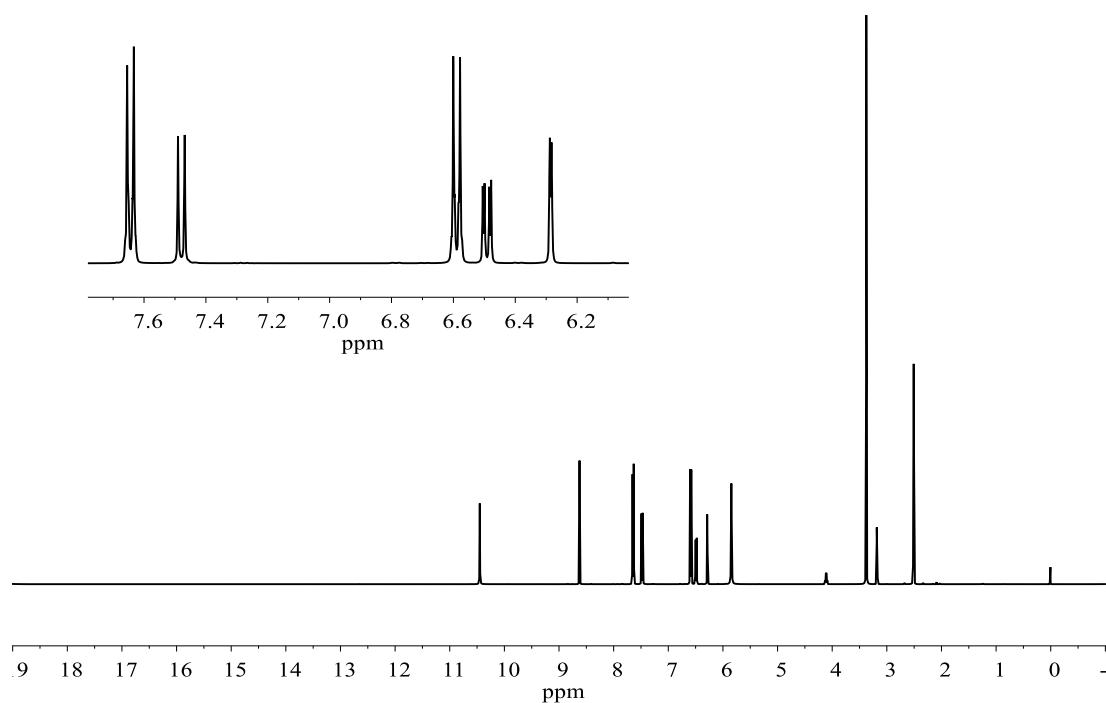
Slika D21. <sup>1</sup>H NMR spektar kompleksnog spoja **2a** s uvećanim prikazom signala od 6,1 do 7,8 ppm
