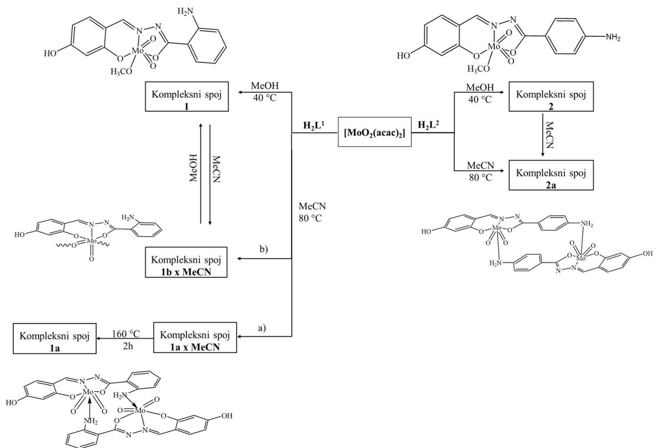
Shema 4. Sinteza mononuklearnih, dinuklearnih i polinuklearnih kompleksnih spojeva molibdena(VI) sa hidrazonskim ligandima
