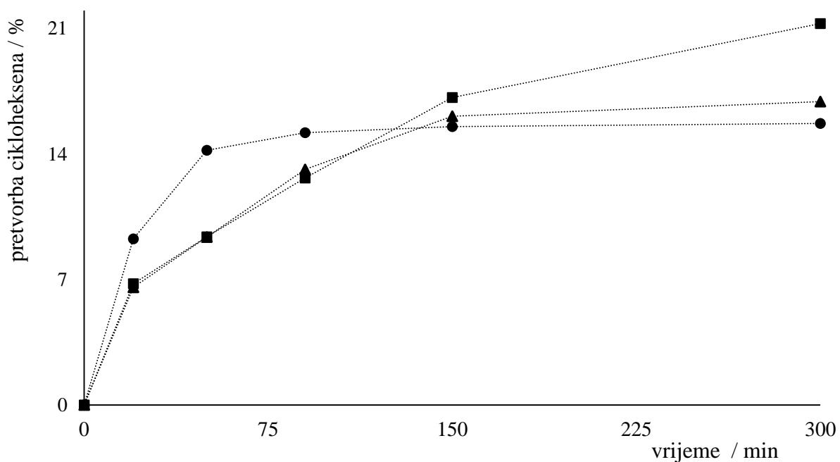
Slika D36. Pretvorba cikloheksena u vremenu uz Mo(VI) kompleksne spojeve kao katalizatore. Udio katalizatora je 0,25 %, a kao oksidans je korišten  $\text{H}_2\text{O}_2$  gdje ▲ odgovara kompleksnom spoju **1a**×MeCN, ● kompleksnom spoju **1b**×MeCN, a ■ kompleksnom spoju **2a**
