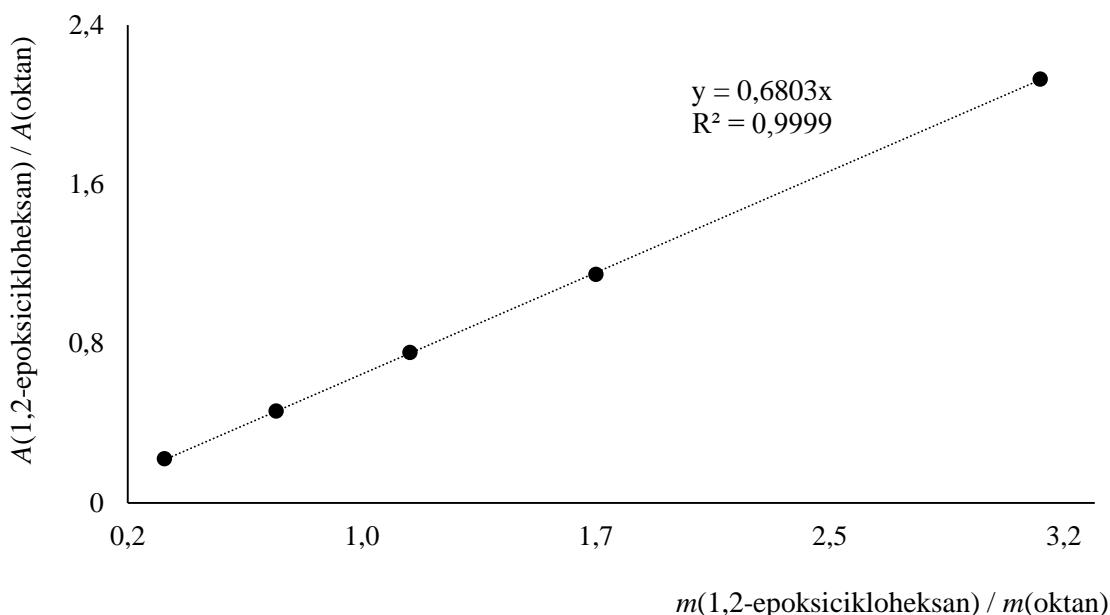
Slika D35. Kalibracijska krivulja za 1,2-epoksicikloheksan, dobivena mjeranjima metodom plinske kromatografije uz oktan kao unutarnji standard
