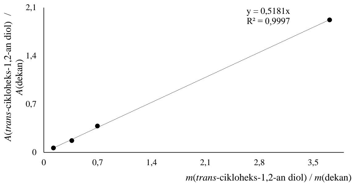
Slika D33. Kalibracijska krivulja za *trans*-cikloheks-1,2-an diol, dobivena mjeranjima metodom plinske kromatografije uz dekan kao unutarnji standard
