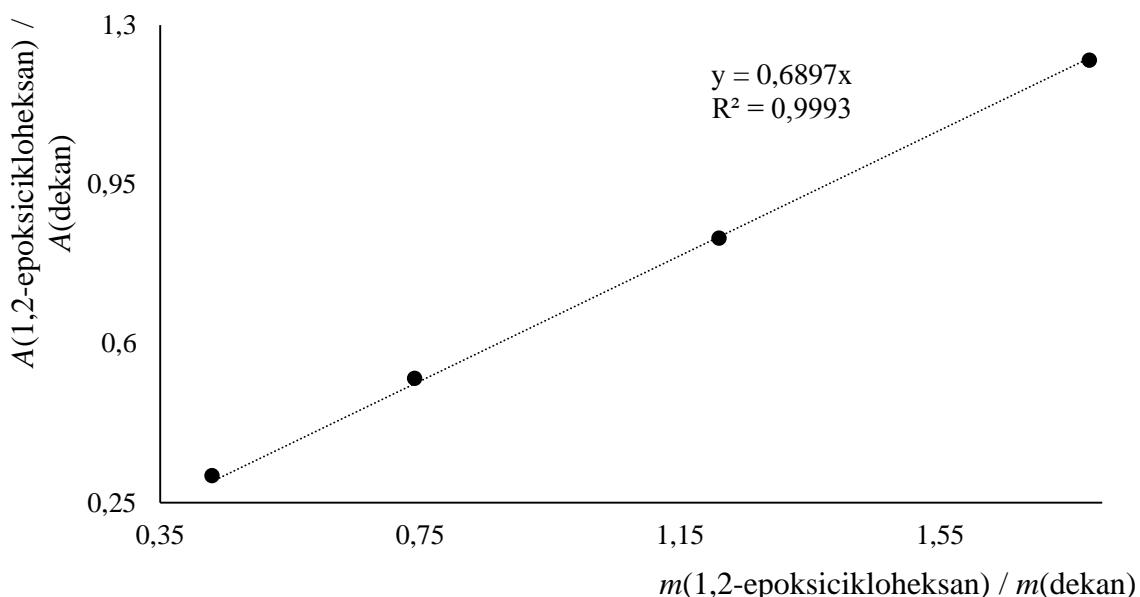
Slika D32. Kalibracijska krivulja za 1,2-epoxycikloheksan, dobivena mjerjenjima metodom plinske kromatografije uz dekan kao unutarnji standard
