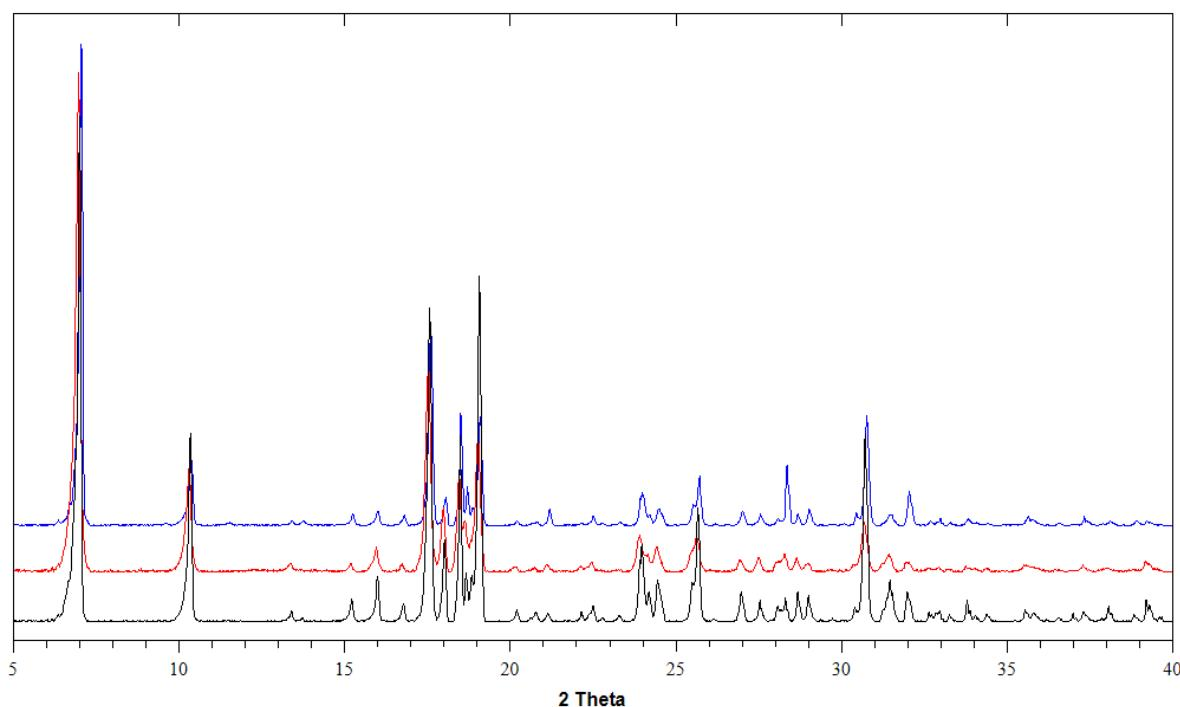
Slika D26. Usporedba difraktograma praha kompleksnog spoja **1b×MeCN** dobivenog sintezom iz otopine (crno), mehanokemijskom sintezom (crveno) i pretaloživanjem **1** u acetonitrilu (plavo)
