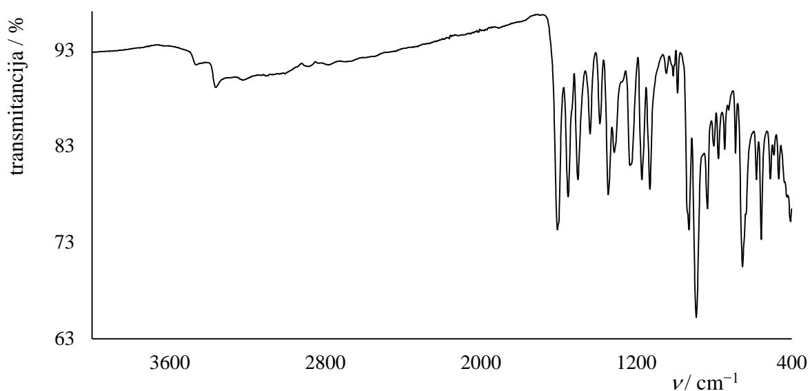
Slika D9. IR spekar kompleksnog spoja **2**
