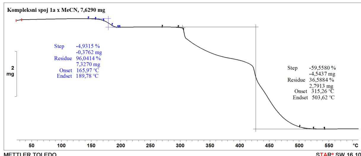
Slika D12. Termogram kompleksnog spoja 1a×MeCN
