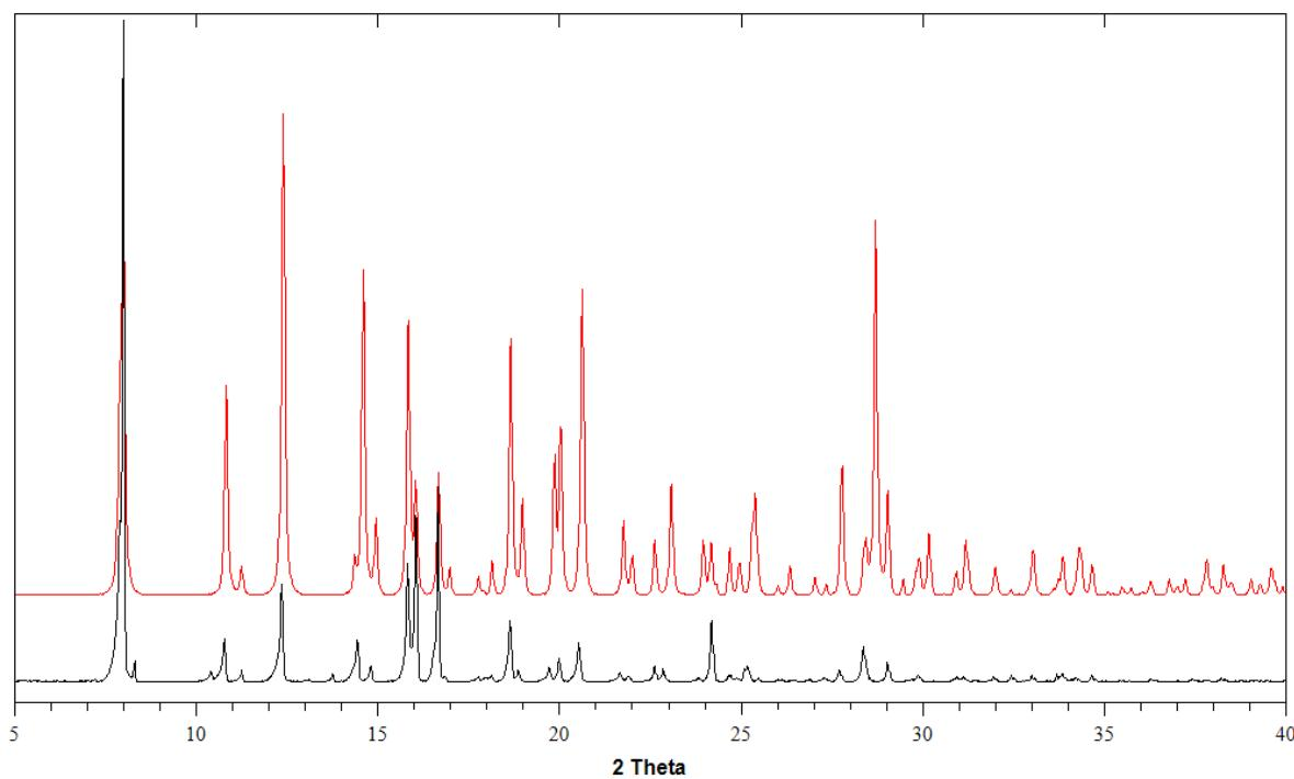
Slika D25. Usporedba difraktograma praha kompleksnog spoja **1a×MeCN** dobivenog iz otopine (crno) i izračunatog difraktograma praha iz podataka dobivenih rendgenskom strukturnom analizom (crveno)
