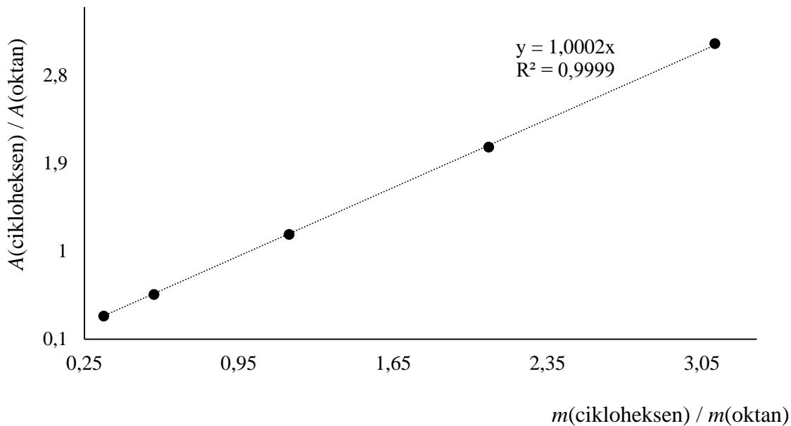
Slika D34. Kalibracijska krivulja za cikloheksen, dobivena mjeranjima metodom plinske kromatografije uz oktan kao unutarnji standard
