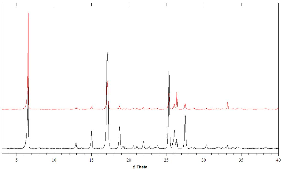
Slika D23. Usporedba difraktograma praha liganda  $\mathbf{H}_2\mathbf{L}^2$  dobivenog mehanokemijskom sintezom nakon 50 min mljevenja (crno) i difraktograma praha liganda  $\mathbf{H}_2\mathbf{L}^2$  dobivenog otopinskom sintezom (crveno)
