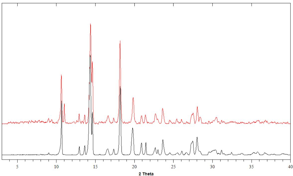
Slika D29. Usporedba difraktograma praha kompleksnog spoja **2a** dobivenog sintezom iz otopine (crno) i kompleksnog spoja **2a** dobivenog pretaloživanjem komplexnog spoja **2** u acetonitrilu (crveno)
