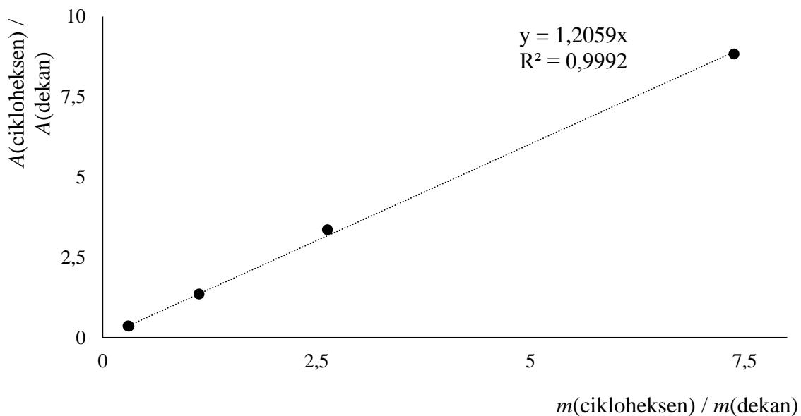
Slika D31. Kalibracijska krivulja za cikloheksen, dobivena mjerjenjima metodom plinske kromatografije uz dekan kao unutarnji standard
