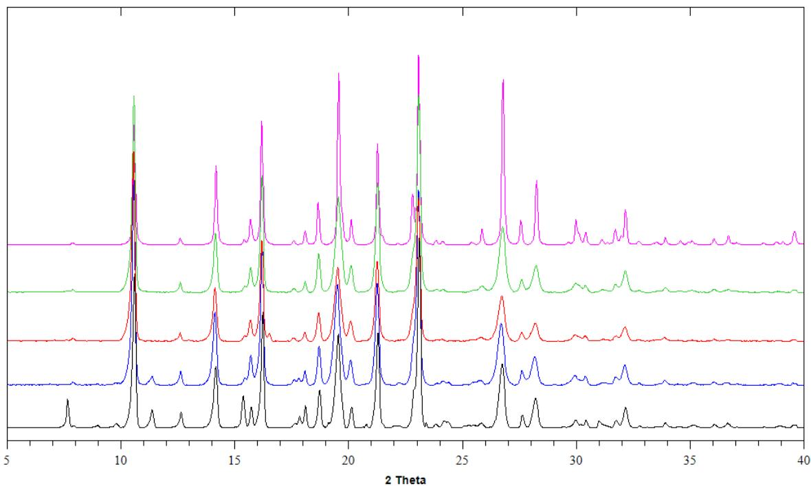
Slika 11. Prikaz praćenja nastanka liganda ( $\mathbf{H}_2\mathbf{L}^1$ ) PXRD metodom: difraktogram spoja nakon 10 min mljevenja (crno), difraktogram spoja nakon 20 min mljevenja (plavo), difraktogram spoja nakon 30 min mljevenja (crveno), difraktogram spoja nakon 40 min mljevenja (zeleno), difraktogram liganda  $\mathbf{H}_2\mathbf{L}^1$  izračunat iz podataka dobivenih rendgenskom strukturnom analizom (rozo)
