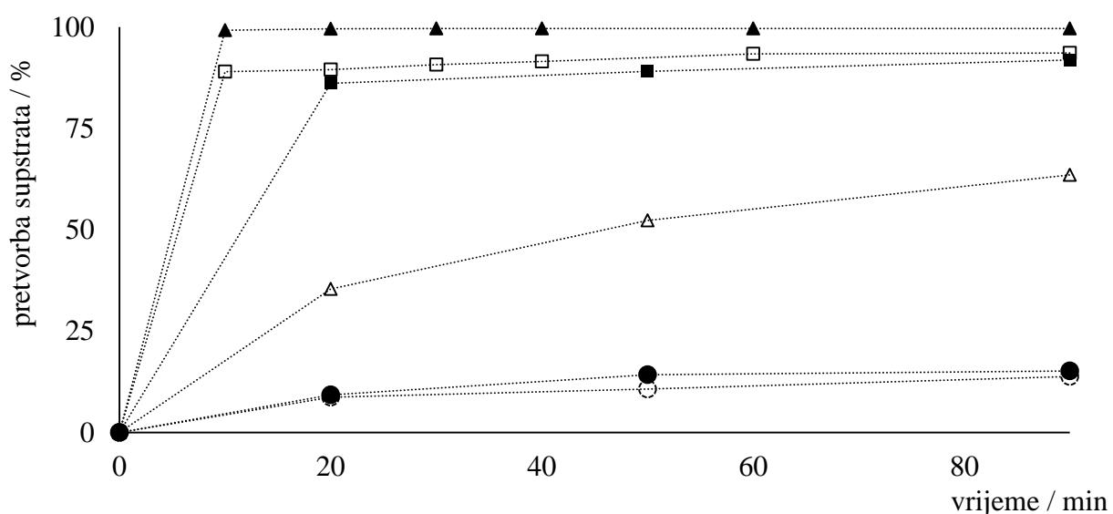
Slika 14. Utjecaj udjela katalizatora na katalitičku aktivnost kompleksnog spoja **1a×MeCN** u reakcijama s različitim oksidansima, ■ 0,05 mmol katalizatora s vodenom otopinom TBHP, □ 0,01 mmol katalizatora s vodenom otopinom TBHP, ▲ 0,05 mmol katalizatora s otopinom TBHP u dekanu, Δ 0,01 mmol katalizatora s otopinom TBHP u dekanu, ● 0,05 mmol katalizatora s vodikovim peroksidom, ○ 0,01 mmol katalizatora s vodikovim peroksidom
