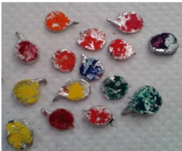
Slika 4.3 Priprema meta praškastih uzoraka čistih pigmenata utisnutih u indij korištenih u ovom radu. Preuzeto iz [ 18].
