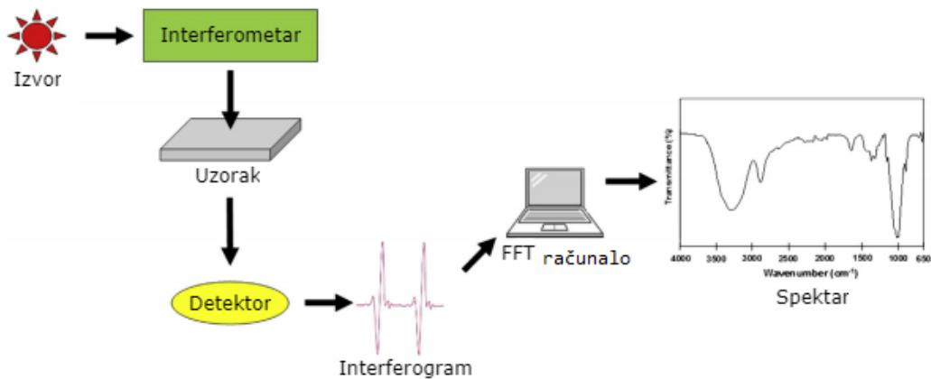
**Slika 5. 3** Shematski prikaz spektrometra za FTIR analizu.
