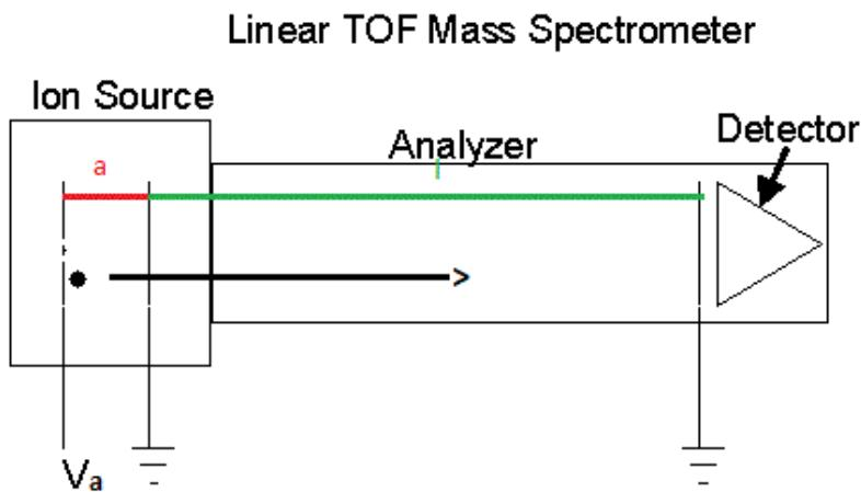
Slika 3.3 Shematski prikaz linearног TOF masenog spektrometra
