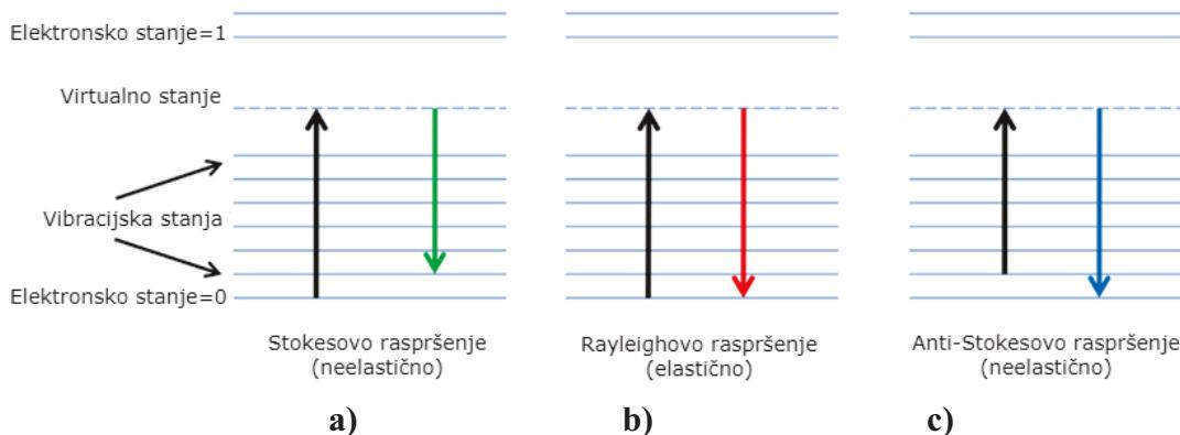
**Slika 5.9** Shematski prikaz sve tri vrste mogućih raspršenja
