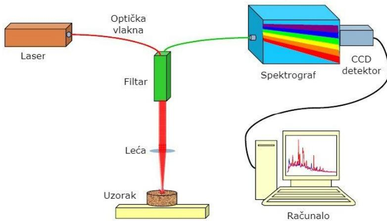
**Slika 5. 7** Shematski postav spektrometra za Raman analizu.
