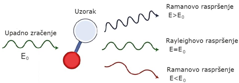
**Slika 5.8** Shematski prikaz Rayleighova i Ramanova raspršenja. Preuzeto i prilagođeno prema [34].
