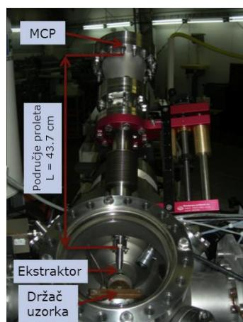
**Slika 4. 2** Komora za mikroprobu sa montiranim linearnim TOF spektrometrom za MeV SIMS.
