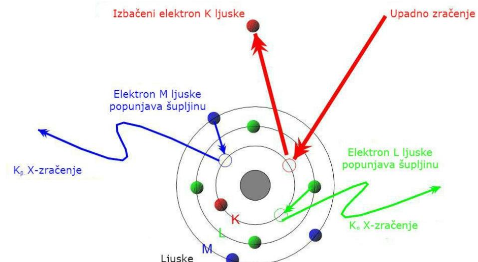
**Slika 5. 1** Shematski prikaz mehanizma emisije X-zračenja. Preuzeto i i prilagođeno prema [20].
