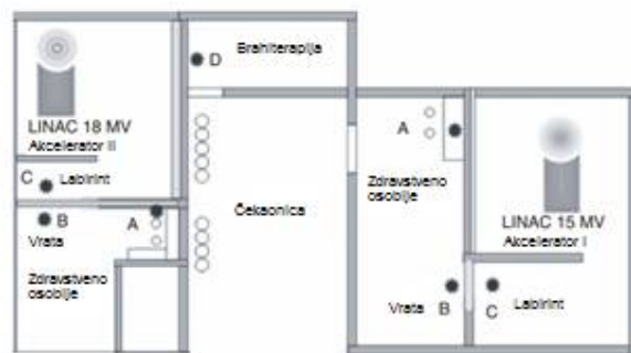
Slika 16. Nacrt bunkera u koje su smješteni akceleratori i okolnih prostorija u KBC Osijek. Mjerni položaji označeni su zvjezdicom.
