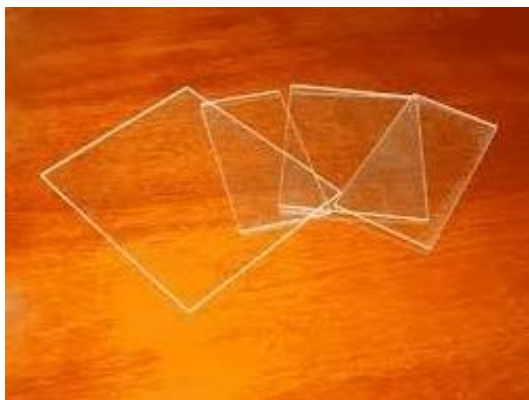
Slika 18. Čvrsti detektor nuklearnih tragova CR-39.
