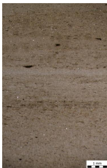
Slika 7.37. Bušotina B-10; Jezgra-6, 2. metar (petrografski izbrusak)- organska tvar te siliciklastična zrna unutar madstona
