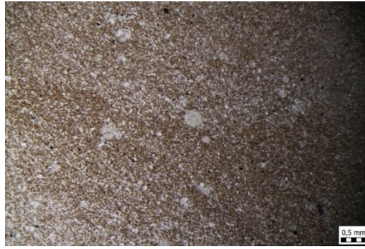
Slika 7.27. Bušotina B-6; jezgra-10 (petrografski izbrusak)-madston do vekston
