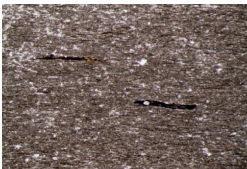
Slika 7.60. Bušotina B-23; jezgra-4/1 m (petrografski izbrusak) pukotine ispunjene organskom tvari u madstonu ili diskontinuirane planparalelne lamine organske tvari u madstonu
