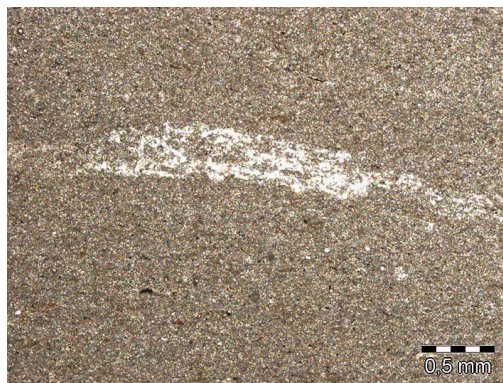
Slika 5.8. Bušotina B-5, jezgra-67 (petrografski izbrusak)- glinoviti lapor, nakupine kalcita, globule pirita (Veseli et al., 2013)
