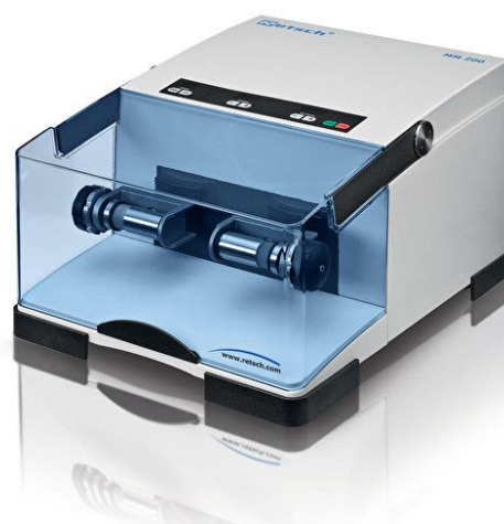
Slika 10. Laboratorijski vibracijski mikromlin 97
