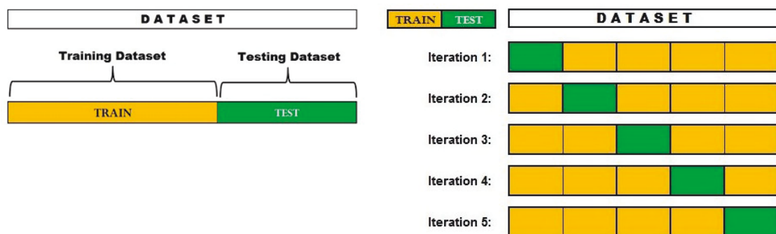
Slika 3.1: Usporedba provjere točnosti modela pomoću metode izdvajanja (lijevo) [42] i k -struke unakrsne provjere (desno) [43].
