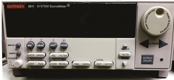
Slika 5.5: Keithley 2611 mjerni uređaj
