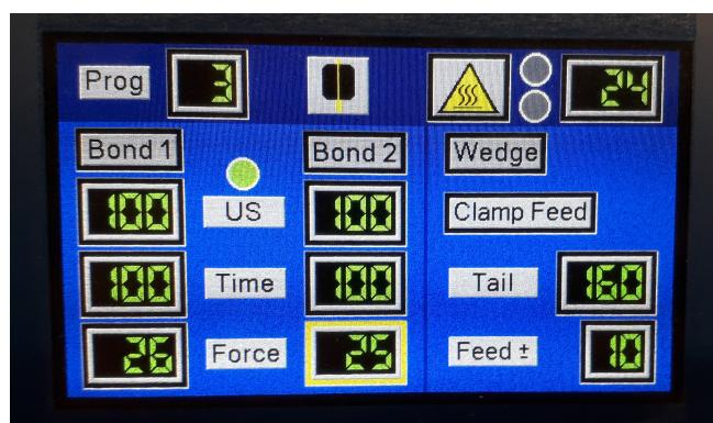
Slika 4.4: Postavke za "wedge bonding"
