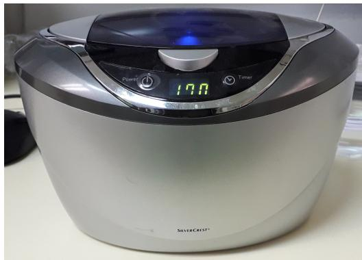
Slika 4.1: Ultrazvučna kada
