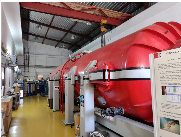
Slika 3.2: Tandem Van de Graaff ubrzivač.
