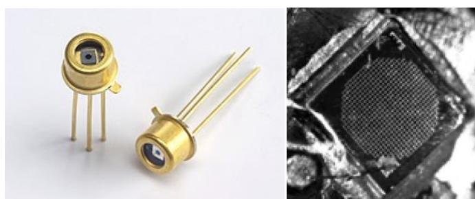
**Slika 2.18.** SSPM detektor površine  $1 \text{ mm}^2$ : u TO-46 kućištu (vanjski promjer 4.72mm) (lijevo); uvećana slika aktivnog dijela površine na kojem se vidi mnoštvo piksela dimenzija  $20 \mu\text{m} \times 20 \mu\text{m}$ . Prikazan je model SSPM\_0701BGŠvicarske tvrtke Photonique SA [27].
