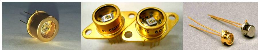
**Slika 2.9.** Fotografije raznih kućišta u koje se pakira "debel" lavinska foto dioda C30902 kanadske tvrtke Excelitas (bivši Perkin Elmer Photonics), slijeva na desno: kućište TO-37 (promjer 12.3 mm) verzija jednostepenim TEC (omogućuje hlađenje do 0 °C) i dvostepenim TEC (omogućuje hlađenje do -20 °C) i kućište TO-46 (promjer 4.7 mm, bez hladila samo chip koji sadrži diodu).
