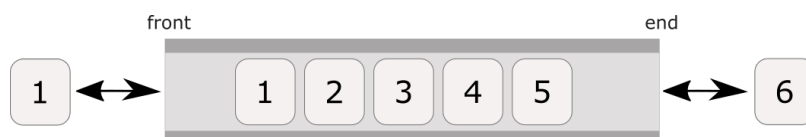
Slika 2.19: Princip rada dvostranog reda
