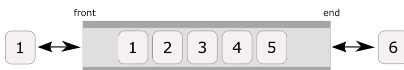
Slika 2.19: Princip rada dvostranog reda
