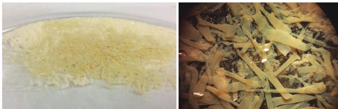
Slika 4.3. Sintetizirane veće kubične nanočestice  $\text{CeO}_2$ ; 2. Sinteza. Osušen produkt u Petrijevoj zdjelici (lijevo), isti produkt snimljen optičkim mikroskopom (desno).
