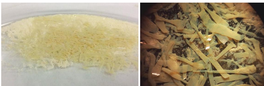
Slika 4.3. Sintetizirane veće kubične nanočestice CeO_2 ; 2. Sinteza. Osušeni produkt u Petrijevoj zdjelici (lijevo), isti produkt snimljen optičkim mikroskopom (desno).
