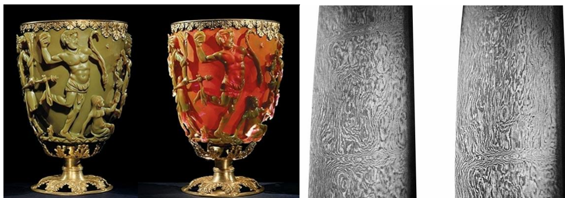
Slika 2.1. Primjeri antičkih nanomaterijala: rimska Likorova čaša s nanočesticama zlata i srebra (lijevo), uvećani prikaz antičkog damašćanskog čelika (desno). 29
