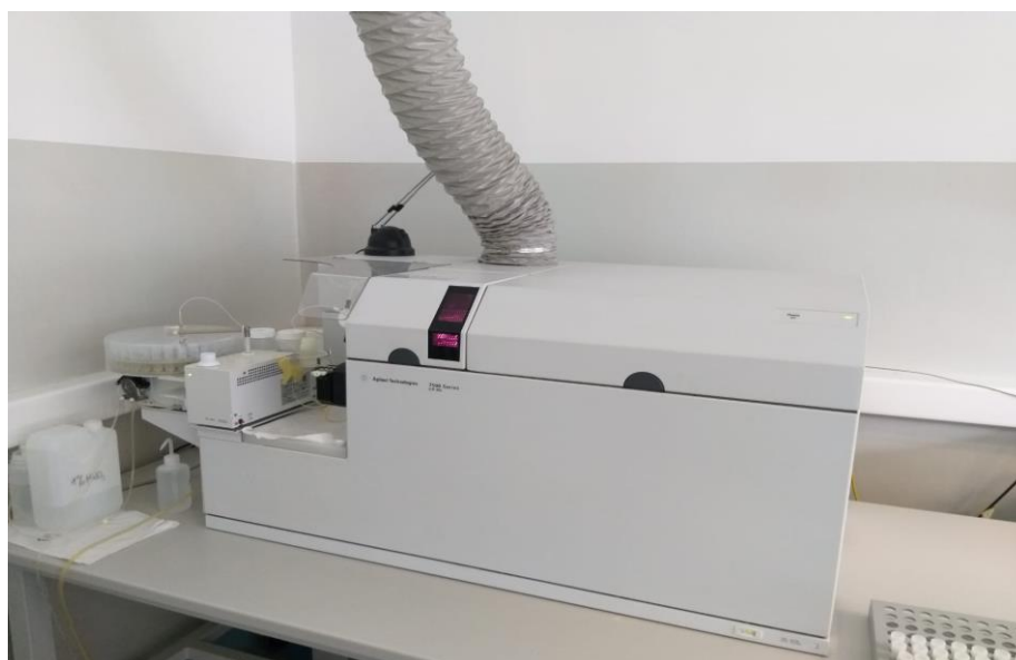
Slika 9. ICP–MS uređaj Agilent 7500cx (Agilent Technologies, Njemačka) za određivanje elemenata.
