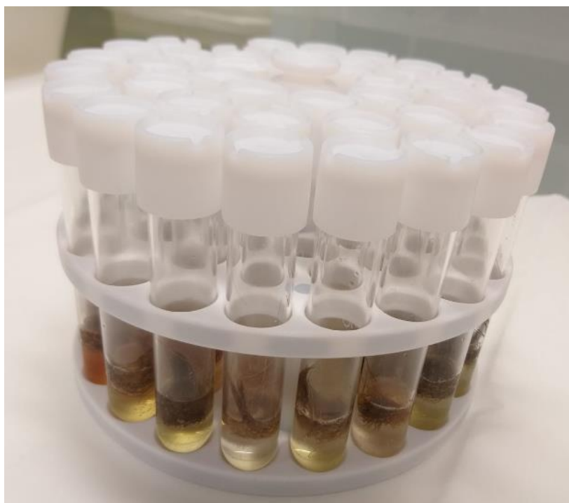
Slika 7. Uzorci kose u kvarcnim epruvetama zatvorenim teflonskim čepovima.
