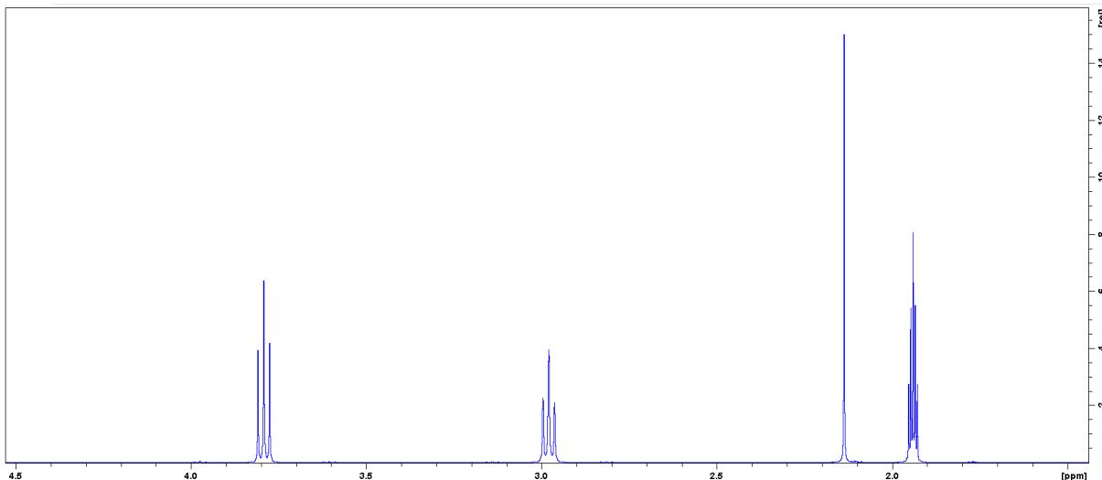
Slika D11. Spektar <sup>1</sup>H NMR fenil izotiocijanata ( $\gamma = 5,0 \text{ mg mL}^{-1}$ ) snimljen u acetonitrilu-*d*3 pri 25 °C.
