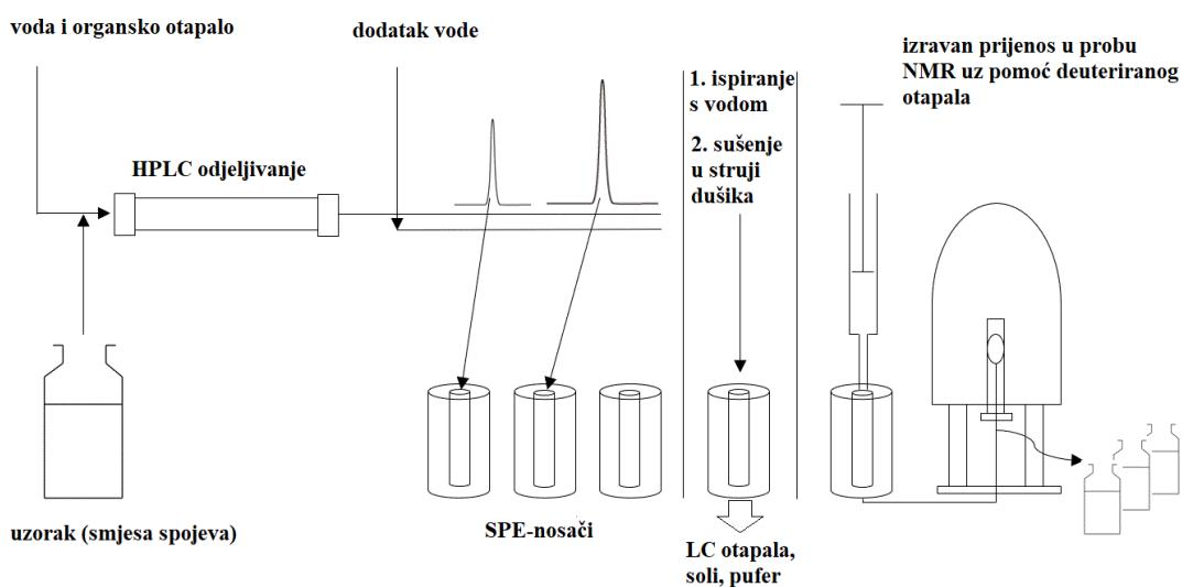
Slika 2.15. Princip rada tehnike HPLC-SPE-NMR.
