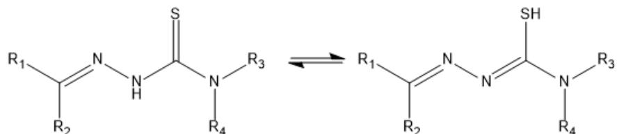
Slika 2.10. Tautomerni oblici tiosemikarbazona, tionski (lijevo) i tiolni (desno).
