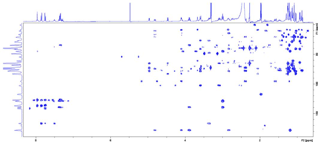
Slika 4.4. Spektar HMBC izoliranog 9a-(2-feniletil)makrozona snimljen u deuteriranom acetonitrilu pri  $25^{\circ}\text{C}$ .
