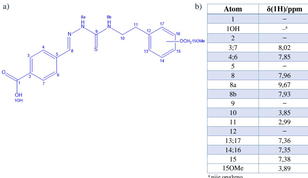
Slika 4.16. a) Predložena struktura; b) kemijski pomaci  $^1\text{H}$  onečićenja Imp RRT 0,515 snimljeni u acetonitrilu-*d*3 pri 25 °C.
