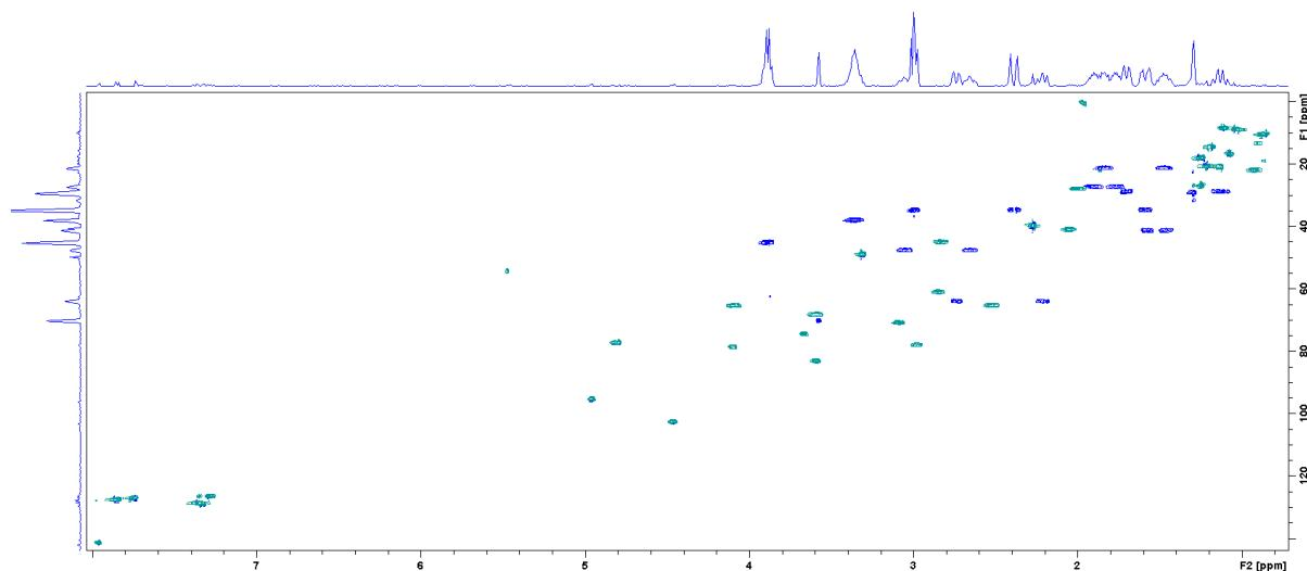
Slika D23. Spektar HSQC 2-feniletil tiosemikarbazida ( $\gamma = 5,0 \text{ mg mL}^{-1}$ ) snimljen u DMSO-
