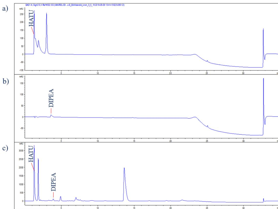
Slika 4.2. Reprezentativni kromatogram a) HATU-a ( $\gamma = 0,02 \text{ mg mL}^{-1}$ ), b) DIPEA-e ( $\gamma = 0,02 \text{ mg mL}^{-1}$ ) i c) reakcijske smjese ( $\gamma = 2,0 \text{ mg mL}^{-1}$ ) dobiven uz kromatografske uvjete prema Tablici 3.2.
