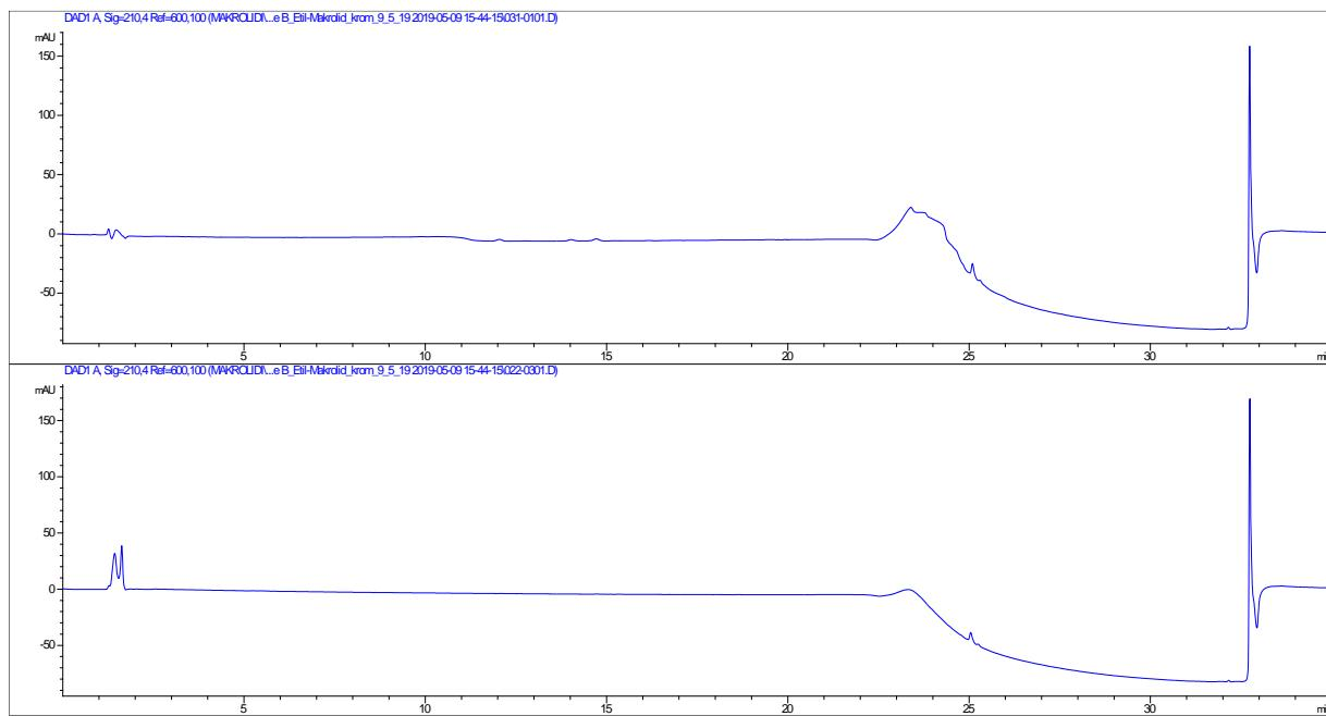
Slika D3. Kromatogram slike probe (acetonitril) i hidrazin monohidrata ( $\gamma = 0,02 \text{ mg mL}^{-1}$ ) dobiven uz kromatografske uvjete prema Tablici 3.2.
