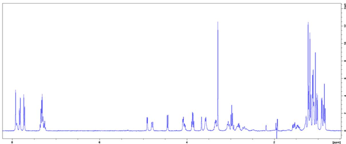
Slika D18. Uvećani prikaz spektra LC-SPE <sup>1</sup>H NMR izoliranog 9a-(2-feniletil)makrozona snimljen u acetonitrilu-*d*3 pri 25 °C.
