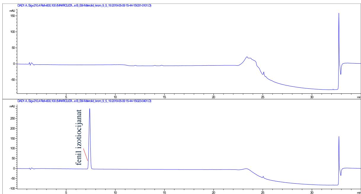
Slika D4. Kromatogram slike probe (acetonitril) i fenil izotiocijanata ( $\gamma = 0,02 \text{ mg mL}^{-1}$ ) dobiven uz kromatografske uvjete prema Tablici 3.2.
