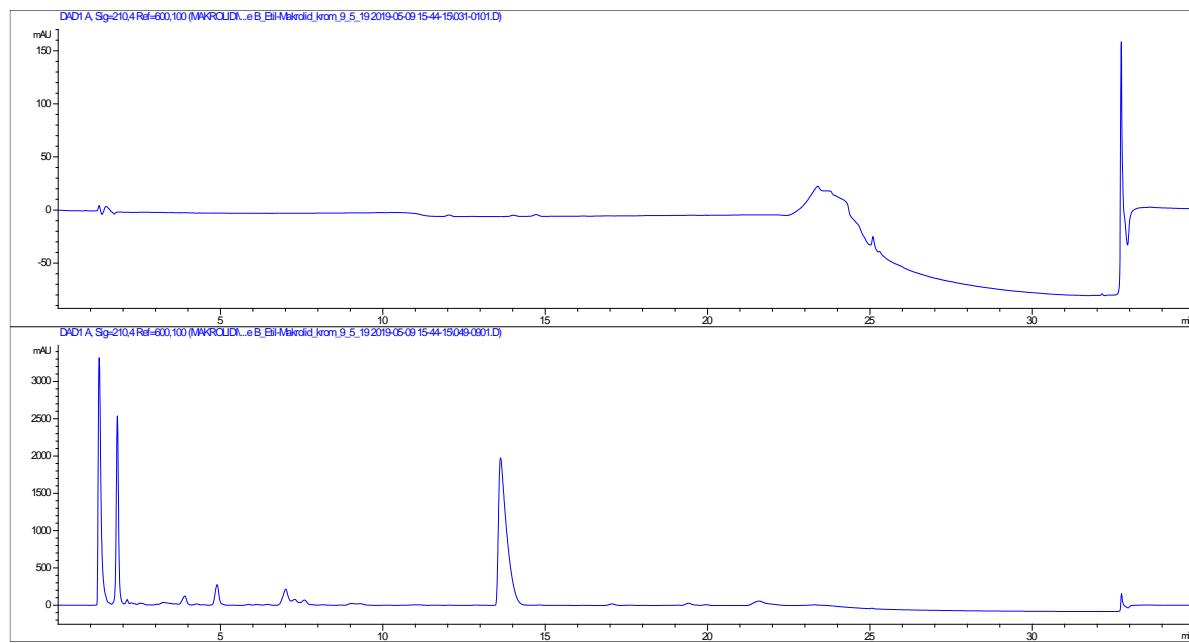
Slika D1. Kromatogram slijeve probe (acetonitril) i reakcijske smjese 9a-(2-feniletil)makrozona ( $\gamma = 2,0 \text{ mg mL}^{-1}$ ) dobiven uz kromatografske uvjete prema Tablici 3.2.
