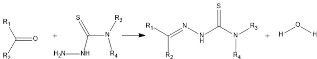
Slika 2.9. Shematski prikaz reakcije dobivanja tiosemikarbazona gdje su R<sub>1</sub>, R<sub>2</sub>, R<sub>3</sub> i R<sub>4</sub> vodik, alkilna, arilna ili heterociklička skupina.
