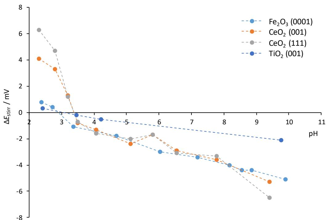
**Slika 5.28.** Ovisnost utjecaja miješanja otopine o pH na monokristalne elektrode napravljene od  $\alpha\text{-Fe}_2\text{O}_3$  (0001) (●),  $\text{CeO}_2$  (001) (●),  $\text{CeO}_2$  (111) (●),  $\text{TiO}_2$  (001) (●). pH je kontroliran dodatcima  $\text{NaOH}$  ( $0,1 \text{ mol dm}^{-3}$ ) otopini  $\text{HCl}$  ( $0,01 \text{ mol dm}^{-3}$ ). Za miješanje otopine korištena je magnetska miješalica. Otopina je termostatirana na  $(25,0 \pm 0,1)^\circ\text{C}$ , u atmosferi argona.
