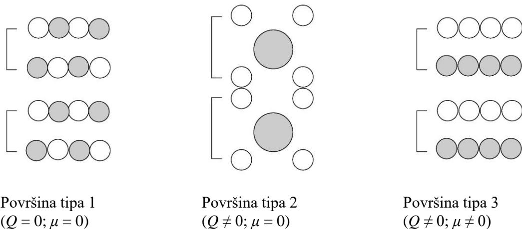
**Slika 2.2.** Klasifikacija površina izolatora prema Taskeru.<sup>49</sup>  $Q$  i  $\mu$  su gustoća naboja pojedinog sloja i dipolni moment u ponavljajućoj jedinici u smjeru okomito na površinu.
