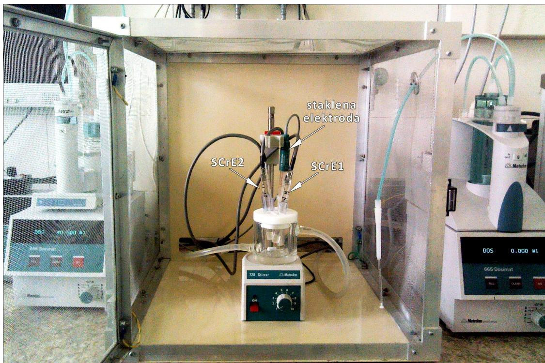
Slika 4.4. Eksperimentalni postav za potenciometrijska mjerena u uzemljenom Faradayevom kavezu.
