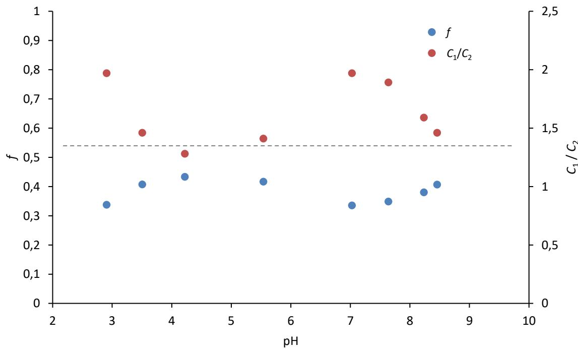
**Slika 5.16.** Ovisnost faktora jakosti plohe hematita (001),  $f$ , i omjera kapaciteta ekvivalentnih kondenzatora,  $C_1/C_2$ , o pH vrijednosti otopine u paralelnom spoju ploha hematita (001) i (101) pri ionskoj jakosti  $I_c = 10^{-3}$  mol dm<sup>-3</sup> i temperaturi od 25 °C. Omjer  $C_1/C_2$  dobiven je numeričkom simulacijom iz modela paralelnog spoja dva kondenzatora.
