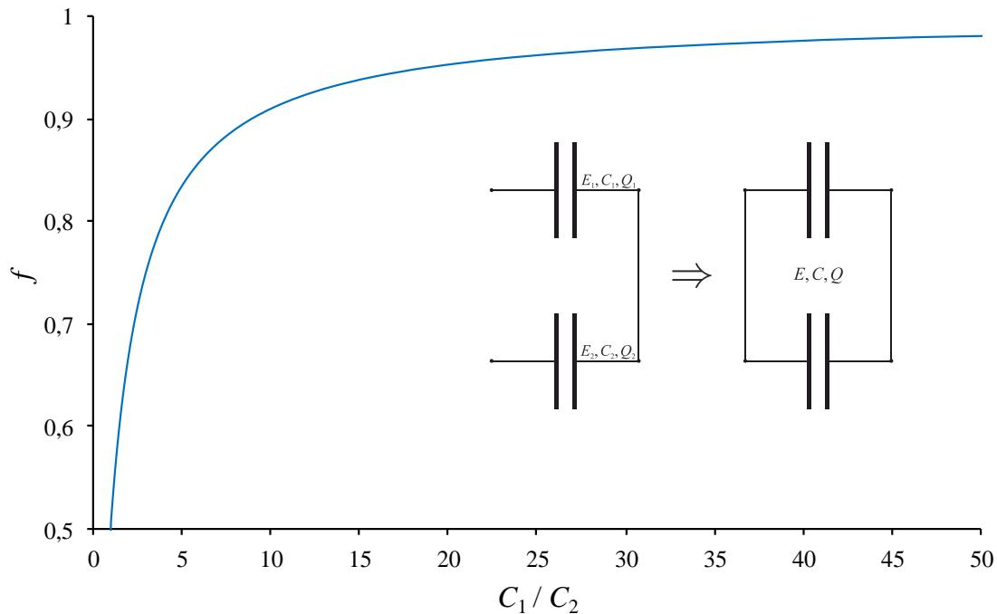
**Slika 3.4.** Ovisnost faktora jakosti kondenzatora,  $f$ , odnosno jakosti pojednostavljenih ploha kristala o omjeru kapaciteta pojedinih kondenzatora/kristala. U simulaciji su prepostavljeni različiti kapaciteti kondenzatora, te su za niz omjera kapaciteta  $C_1:C_2$ , uz pretpostavku ravnomerne raspodjele naboja na spojenim kondenzatorima, izračunati pripadajući im potencijali prije i nakon spajanja, a iz njih faktor  $f$ .
