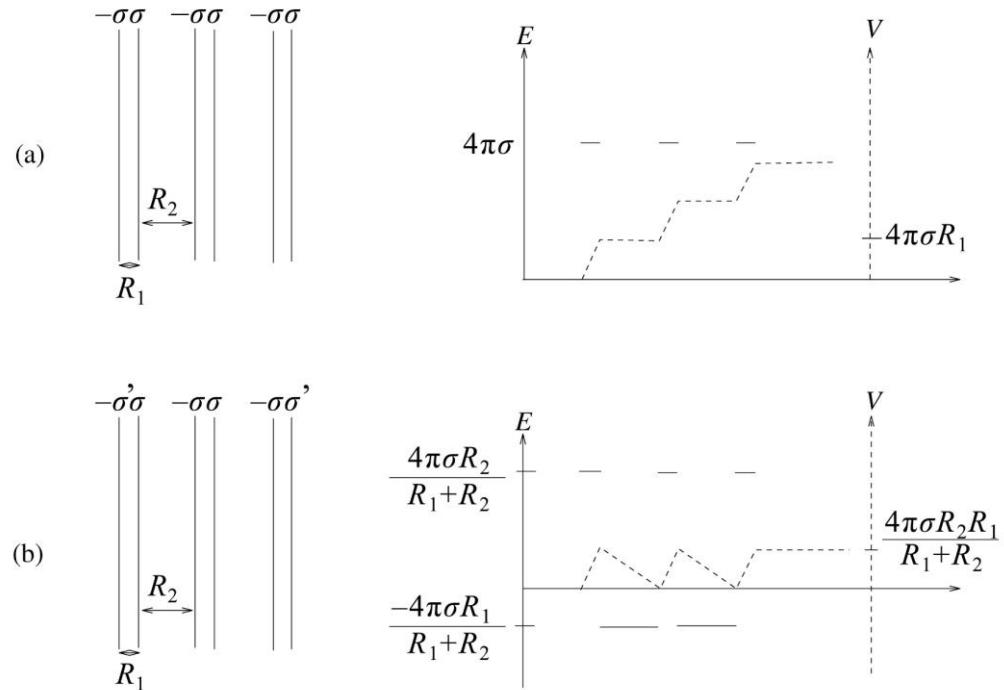
**Slika 2.3.** Prostorne varijacije električnog polja  $E$  i potencijala  $V$  u tijelu kristala izrezanog duž smjera polarnosti.
