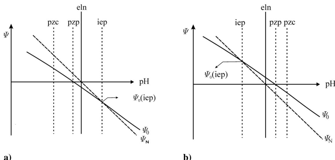
**Slika 2.11.** Odnos između točke elektroneutralnosti (eln), točke nul-naboja (pzc), izoelektrične točke (iep) i točke nul-potencijala za sustav metalnih oksida u slučaju kada je a)  $K_{\text{=K}^+}^\ominus > K_{\text{=A}^-}^\ominus$ ; b)  $K_{\text{=A}^-}^\ominus > K_{\text{=K}^+}^\ominus$ . Crtkanom linijom prikazan je Nernstov potencijal, dok je punom linijom prikazan površinski potencijal.<sup>123</sup>
