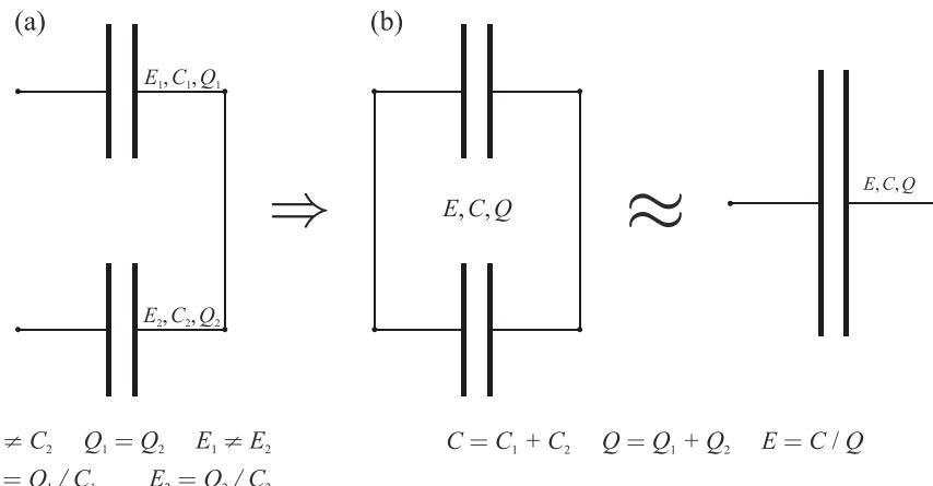
**Slika 3.2.** Prikaz uravnoteženja pojednostavljenog ekvivalentnog strujnog kruga u kojemu su dva različita kondenzatora u otvorenom strujnom krugu nabijena na različite potencijale ( $E_1$  i  $E_2$ ) prije (a) i nakon njihova spajanja. Spojeni kondenzatori mogu se zatim prikazati kao jedan kondenzator (b).
