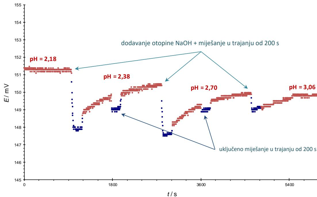
**Slika 5.26.** Uvećanje kiselog područja Slike 5.25. Utjecaj miješanja na mjereni potencijal monokristalne elektrode od hematita,  $\alpha\text{-Fe}_2\text{O}_3$  (0001) prije, za vrijeme i nakon dodatka lužine s isključenim miješanjem (●), i s uključenim miješanjem (○).
