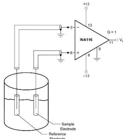
**Slika 4.1.** Visoko-impedancijski voltmeter ( $Z \approx 10^{15} \Omega$ ) za mjerena elektrodnih potencijala monokristalnih elektroda visokih električnih otpornosti. Osjetljivost je postignuta korištenjem integriranog linearног pojačala INA116 prema shemi (desno).
