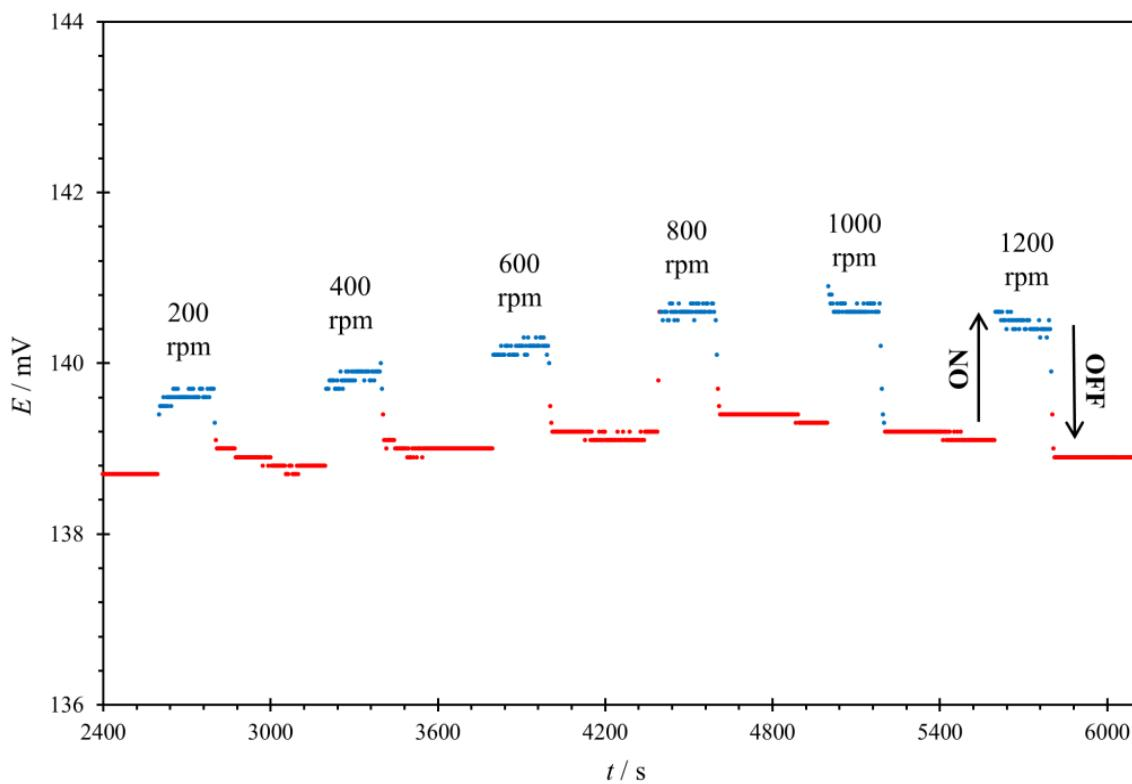
**Slika 5.27.** Utjecaj brzine miješanja na potencijal monokristalne elektrode od hematita,  $\alpha\text{-Fe}_2\text{O}_3$  (0001). Promjene potencijala ovise o brzini miješanja, no pri sve većim brzinama ovisnost manje dolazi do izražaja. Mjerenja su napravljena u atmosferi argona pri  $\text{pH} = 5,0 \pm 0,2$ ,  $(25,0 \pm 0,1)$  °C i  $I_c \approx 0,001$  mol dm<sup>-3</sup> koji je podešen dodatkom otopine NaCl.
