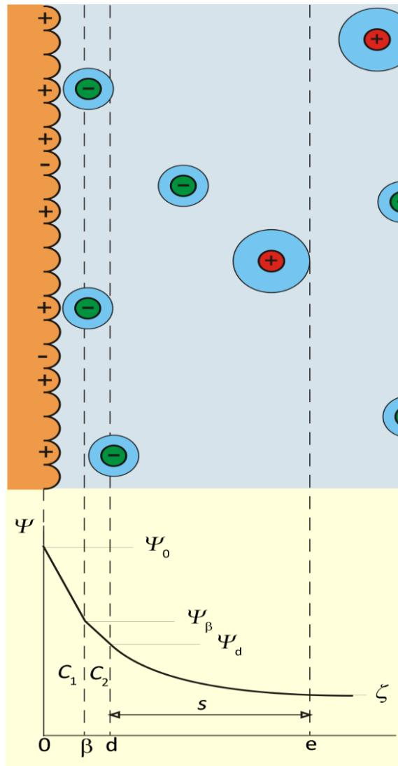
Slika 2.7. Opći model električkog međupovršinskog sloja.<sup>69</sup>
