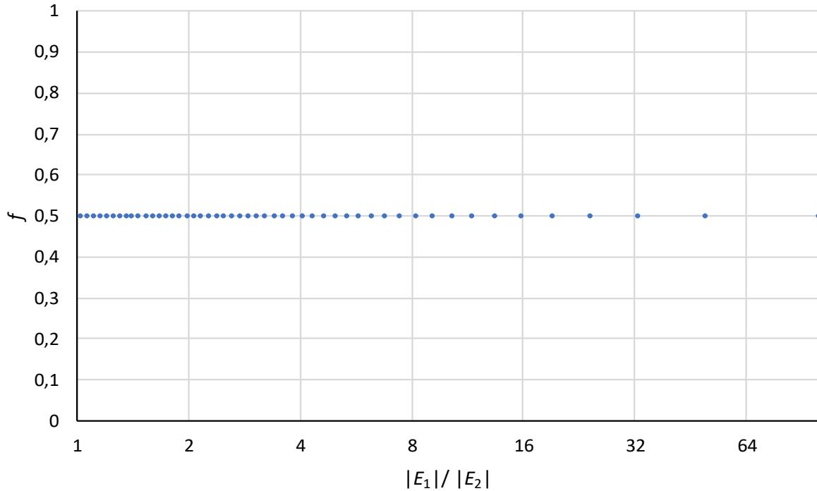
**Slika 3.6.** Računalna simulacija ovisnosti faktora jakosti pojednostavljenih ploha kristalā,  $f$ , o omjeru potencijala pojedinih kristala, uz pretpostavku da isključivo unutrašnji otpor kristala utječe na zajednički potencijal spojenih elektroda. Radi jednostavnosti, os  $x$  prikazana je s logaritamskom podjelom. Simulacija pokazuje da je za bilo koji postavljeni omjer potencijala kao rezultat moguće dobiti isključivo faktor  $f = 0,5$ .
