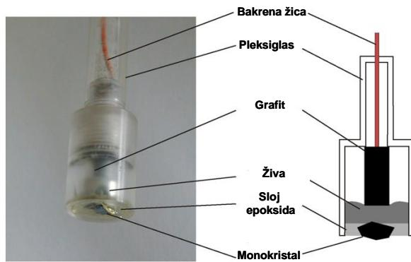
**Slika 2.13.** Fotografija i shematski prikaz monokristalne elektrode.
