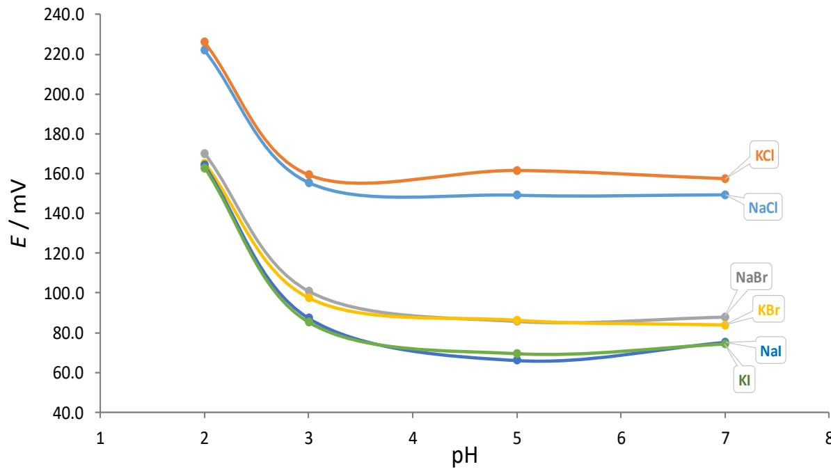
**Slika 5.20.** Ovisnost površinskog potencijala monokristalne elektrode o pH i o sastavu otopine, pri ionskoj jakosti  $I_c = 0,001 \text{ mol dm}^{-3}$ ,  $t = 25^\circ\text{C}$ .
