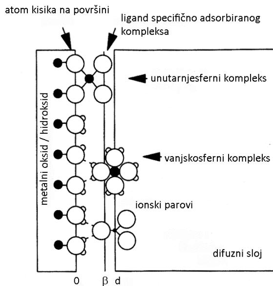
Slika 2.10. Shematski prikaz unutarnjesfernih i vanjskosfernih kompleksa na međupovršini.<sup>5</sup>
