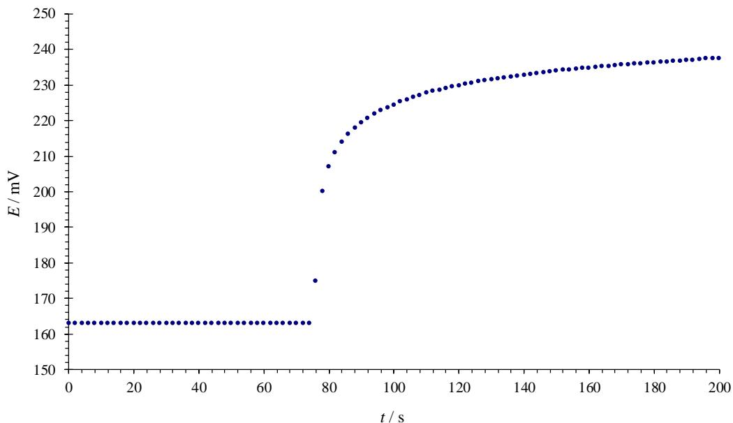
**Slika 5.1.** Promjena izmijerenog potencijala kristalne elektrode rutila,  $\text{TiO}_2$  (100) prilikom spajanja na vanjski izvor električne struje pokazuje karakterističan oblik krivulje koji se ne može pripisati strujnom krugu sastavljenom isključivo od otpornika.
