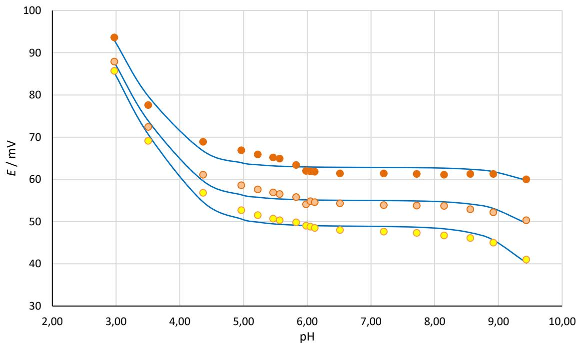
**Slika 5.9.** Mjerenje potencijala dvije elektrode rutila ( $\text{TiO}_2$ ), (100), ● i (110), ○, te potencijala elektroda u kratkom spoju, ○, u ovisnosti o pH. Primjetan je karakterističan oblik krivulje kakav se opaža kod gotovo svih metalnih oksida.
