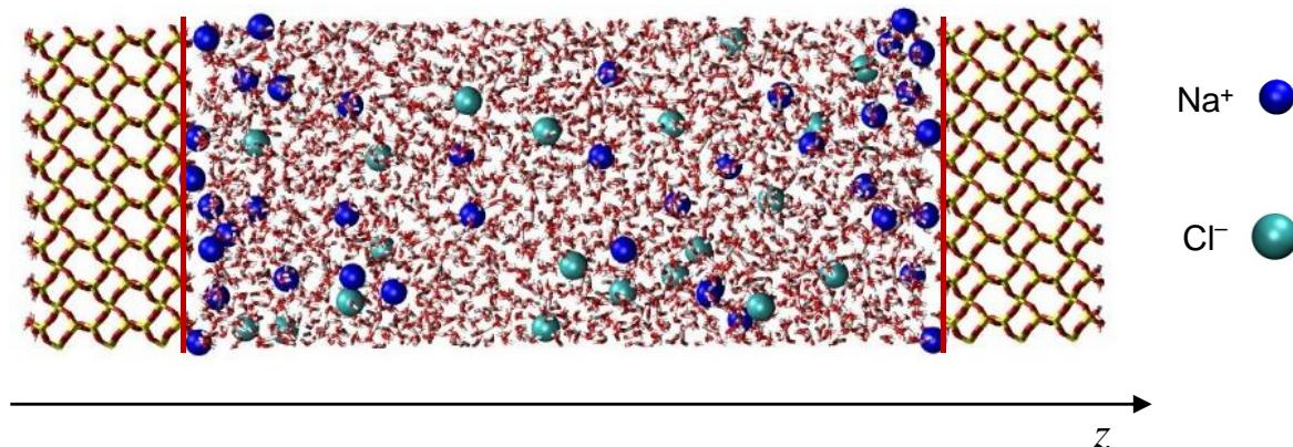
**Slika 5.21.** Simulacijska „kutija“ vodene otopine NaCl između dvije plohe kvarca, SiO<sub>2</sub> (0001), pri pH ≈ 6.<sup>158</sup>
