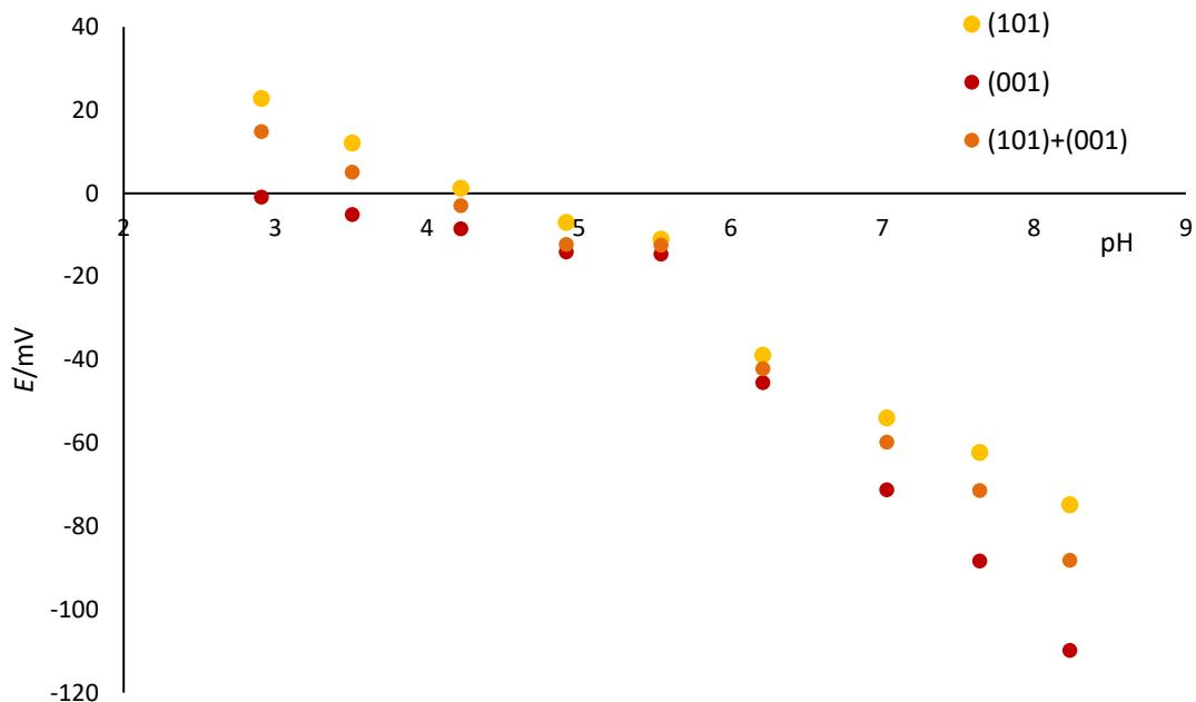
**Slika 5.14.** Ovisnost površinskog potencijala ploha hematita (001) i (101) i zajedničkog potencijala dviju ploha međusobno spojenih električkim kontaktom o pH vrijednosti vodene otopine elektrolita ionske jakosti  $I_c = 10^{-3}$  mol dm<sup>-3</sup> pri 25 °C.
