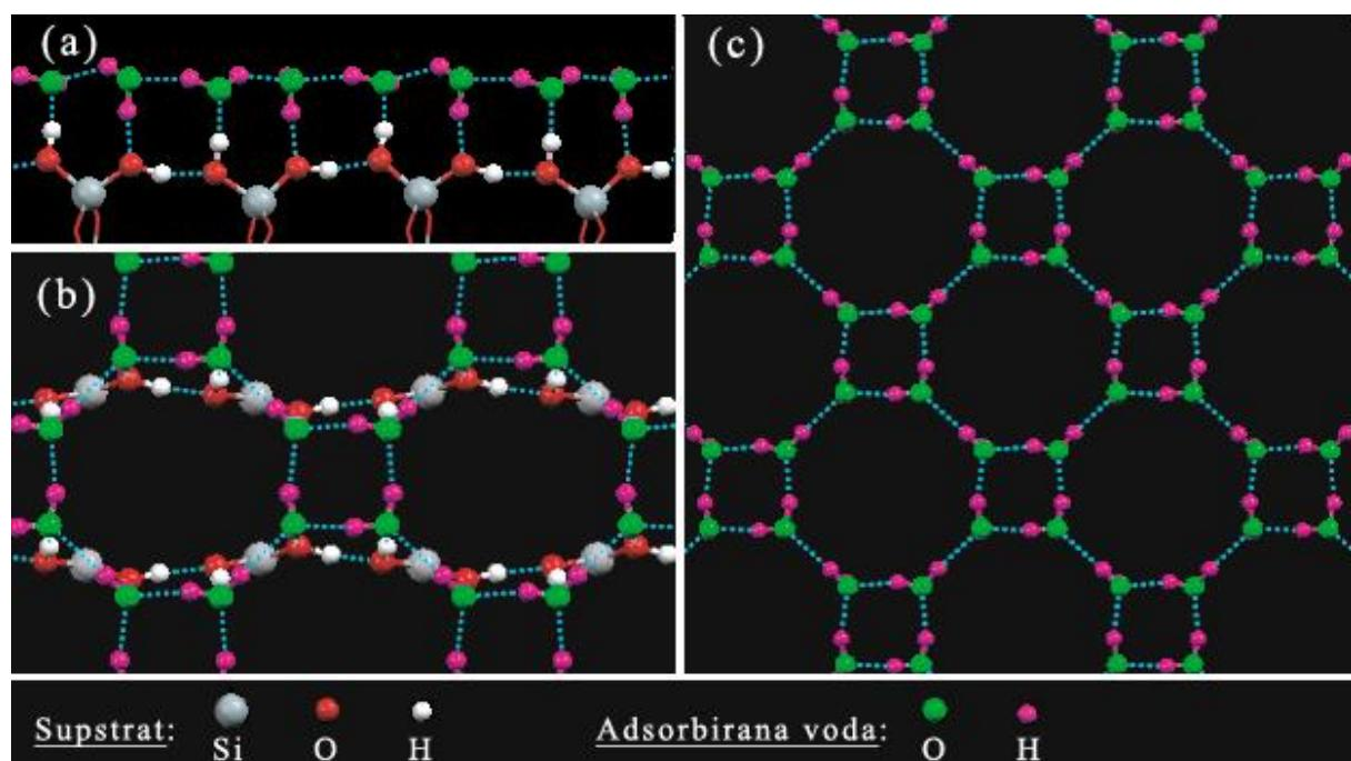
**Slika 2.1.** Optimizirana struktura vode, na površini hidratiziranog  $\beta$ -kristobalita ( $\text{SiO}_2$ ): (a) pogled sa strane; (b) pogled odozgo, (c) pogled odozgo bez atoma supstrata (radi jasnoće). Zamjetan je izostanak postojanja slobodnih OH skupina u smjeru od površine prema otopini.<sup>17</sup>
