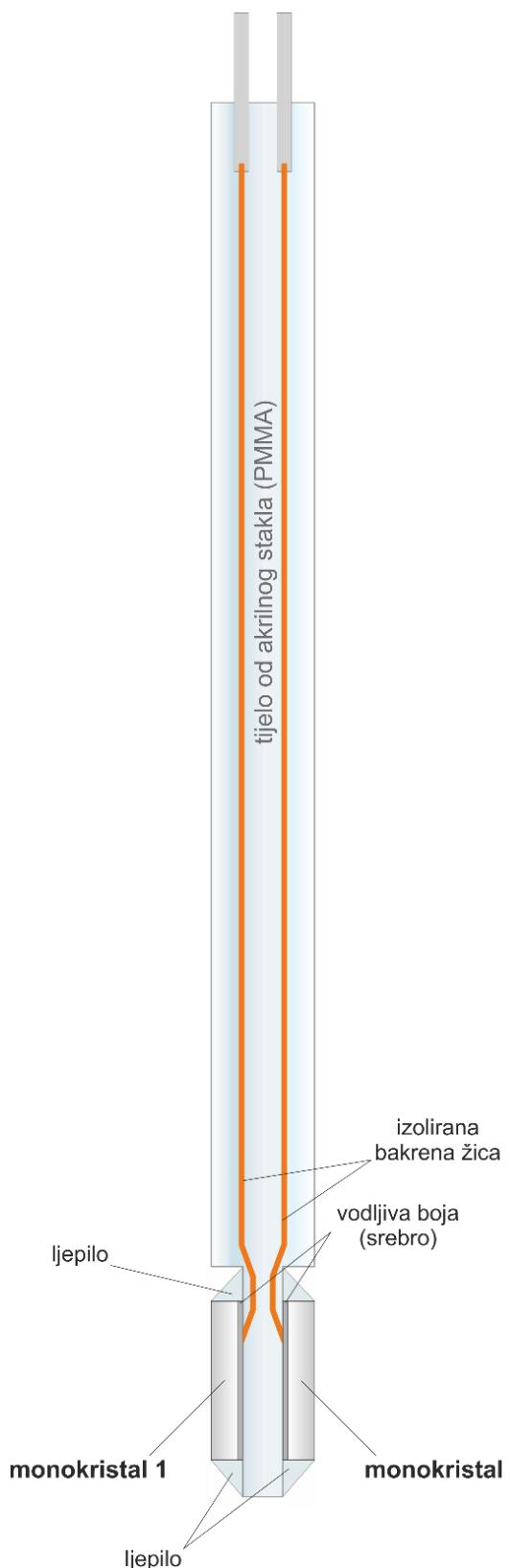
**Slika 4.2.** Shematski prikaz sustava dvije monokristalne elektrode.
