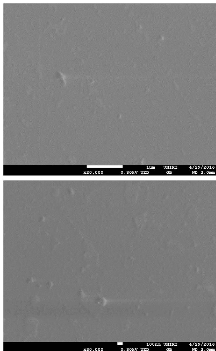
**Slika 5.7.** SEM snimke površine monokristala TiO<sub>2</sub> (100) pri dva različita uvećanja ne pokazuju značajne površinske defekte.
