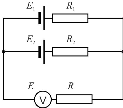
**Slika 3.5.** Shema paralelnog spoja dva izvora istosmjerne struje (dvije elektrode) i mjernog instrumenta (voltmetra) s pripadajućim unutrašnjim otporima.
