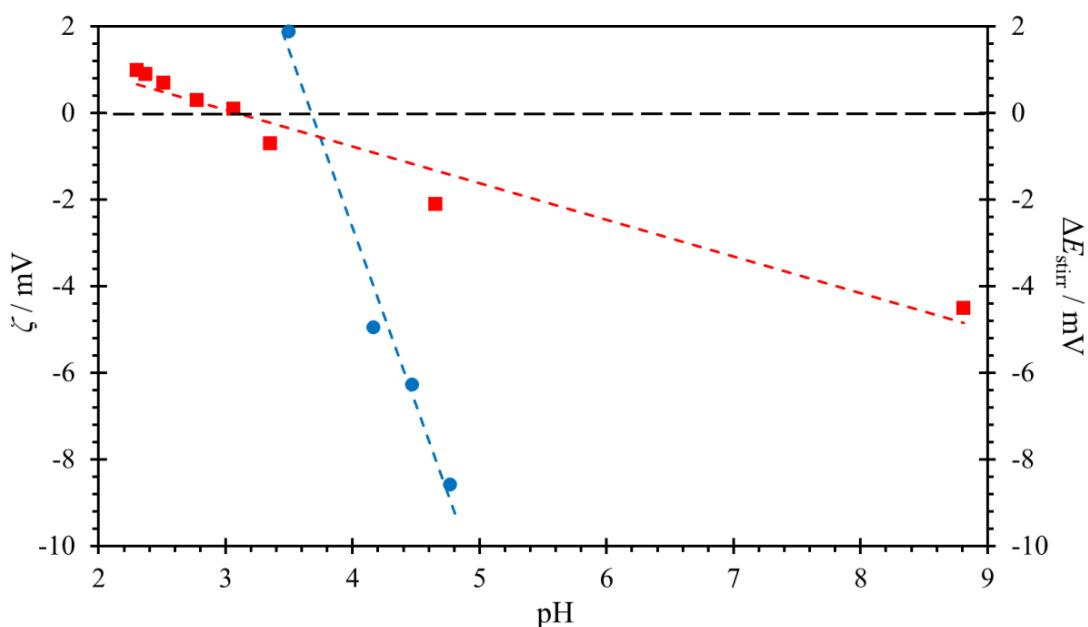
**Slika 5.29.** Usporedni prikaz elektrokinetičkog potencijala strujanja (●) i promjene potencijala prilikom miješanja otopine (■) na monokristalnoj elektrodi od hematita,  $\alpha\text{-Fe}_2\text{O}_3$  (0001). Ionska jakost otopine bila je  $I_c \approx 0,01 \text{ mol dm}^{-3}$ , a kontrolirana je dodatkom NaCl. Sustav je termostatiran na  $(25,0 \pm 0,1)^\circ\text{C}$ , u atmosferi argona.
