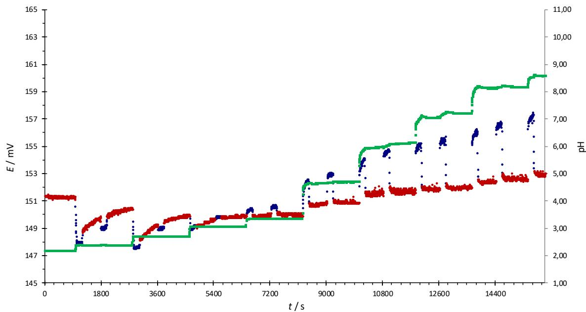
**Slika 5.25.** Potenciometrijska titracija monokristalne elektrode od hematita,  $\alpha\text{-Fe}_2\text{O}_3$  (0001). Potencijal elektrode bez miješanja (●), s uključenim miješanjem (○), i pH izmjerен pomoću staklene elektrode (■). pH je kontroliran dodatcima NaOH u otopini HCl. Miješanje je postignuto magnetskom miješalicom, otopina je termostatirana na  $(25,0 \pm 0,1)$  °C u atmosferi argona.
