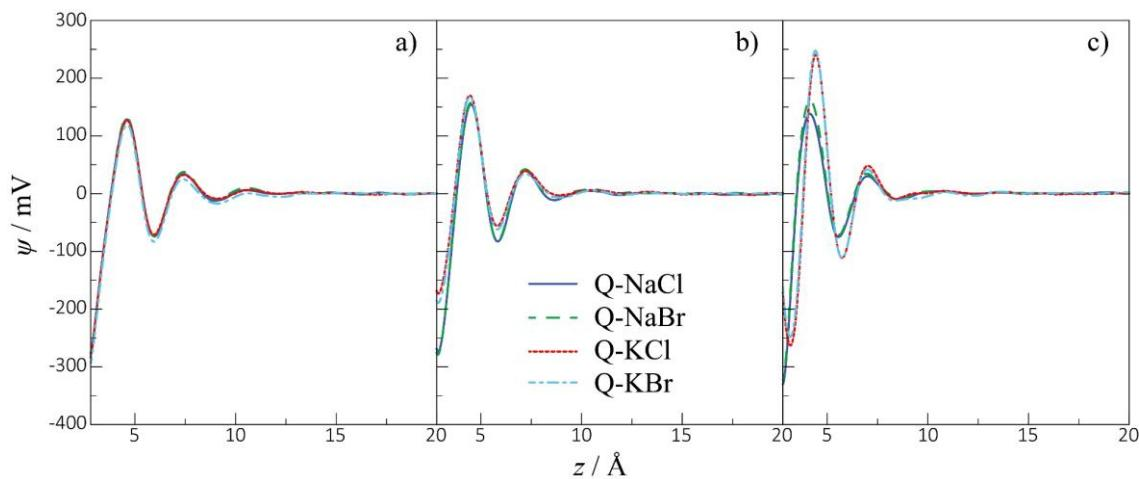
**Slika 5.23.** Elektrostatski potencijal na međupovršini kvarc,  $\text{SiO}_2$  (0001) / vodena otopina elektrolita pri a)  $\text{pH} = 3$ , b)  $\text{pH} = 6$ , i c)  $\text{pH} = 9$ .<sup>158</sup>
