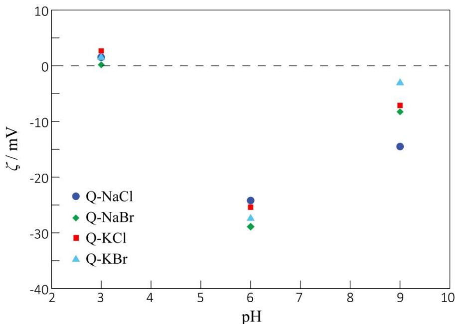
**Slika 5.24.** Izračunate vrijednosti  $\zeta$ -potencijala simuliranog sustava kvarc,  $\text{SiO}_2$  (0001) pri tri pH vrijednosti za vodene otopine: ( $\bullet$ )  $\text{NaCl}$ , ( $\blacklozenge$ )  $\text{NaBr}$ , ( $\blacksquare$ )  $\text{KCl}$  i ( $\blacktriangle$ )  $\text{KBr}$ ,  $c = 0,4 \text{ mol dm}^{-3}$ .
