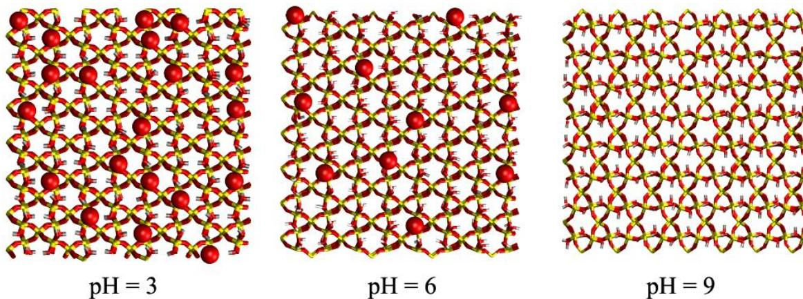
**Slika 5.22.** Modeli površine kvarca, SiO<sub>2</sub> (0001) (duž osi z, v. Sliku 5.21.) koje sadrže 0 %, 9 % i 18 % siloksidnih skupina, pri pH ≈ 3, pH ≈ 6 i pH ≈ 9. Kisikovi atomi, odnosno nabijene siloksidne skupine prikazane su crvenom bojom.<sup>158</sup>
