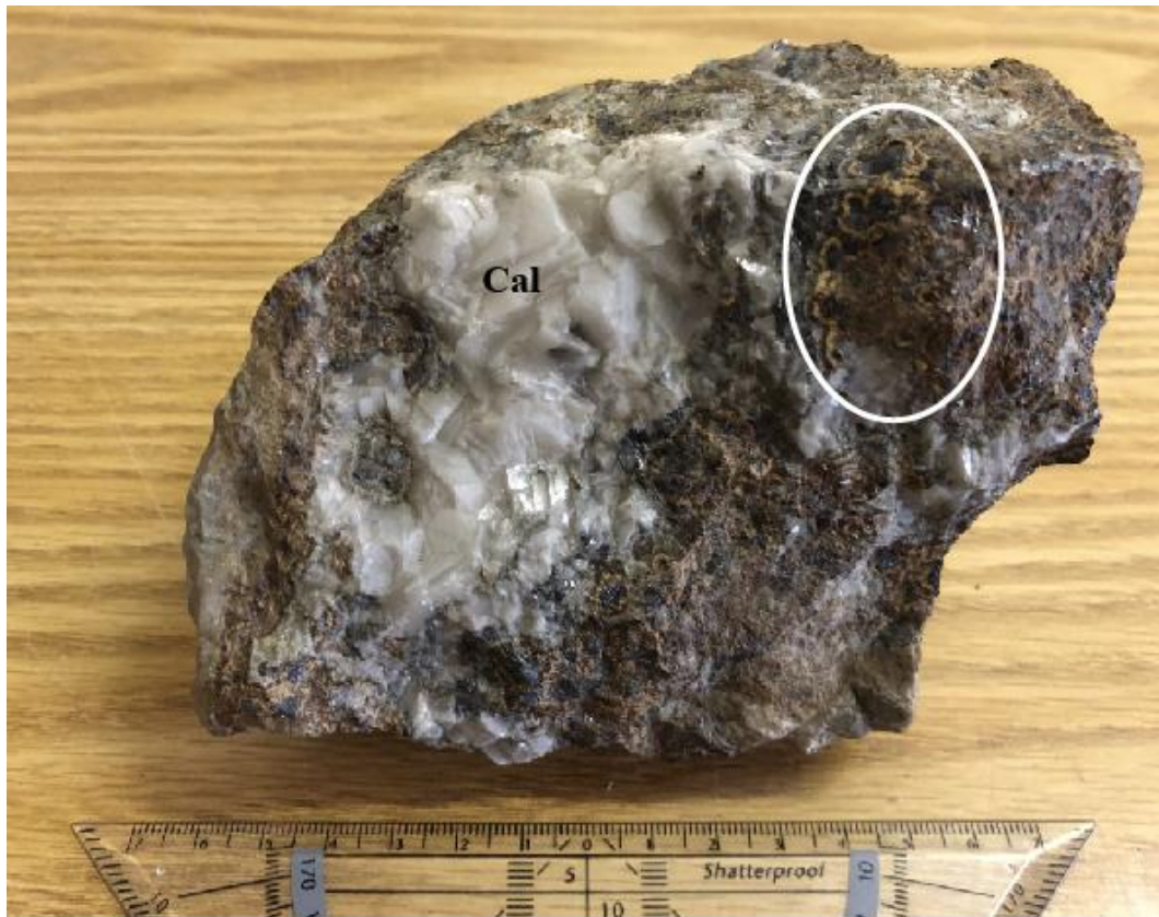
Slika 15. Koloformna tekstura (zaokruženo) na uzorku iz HPM-a. (Cal-kalcit)
