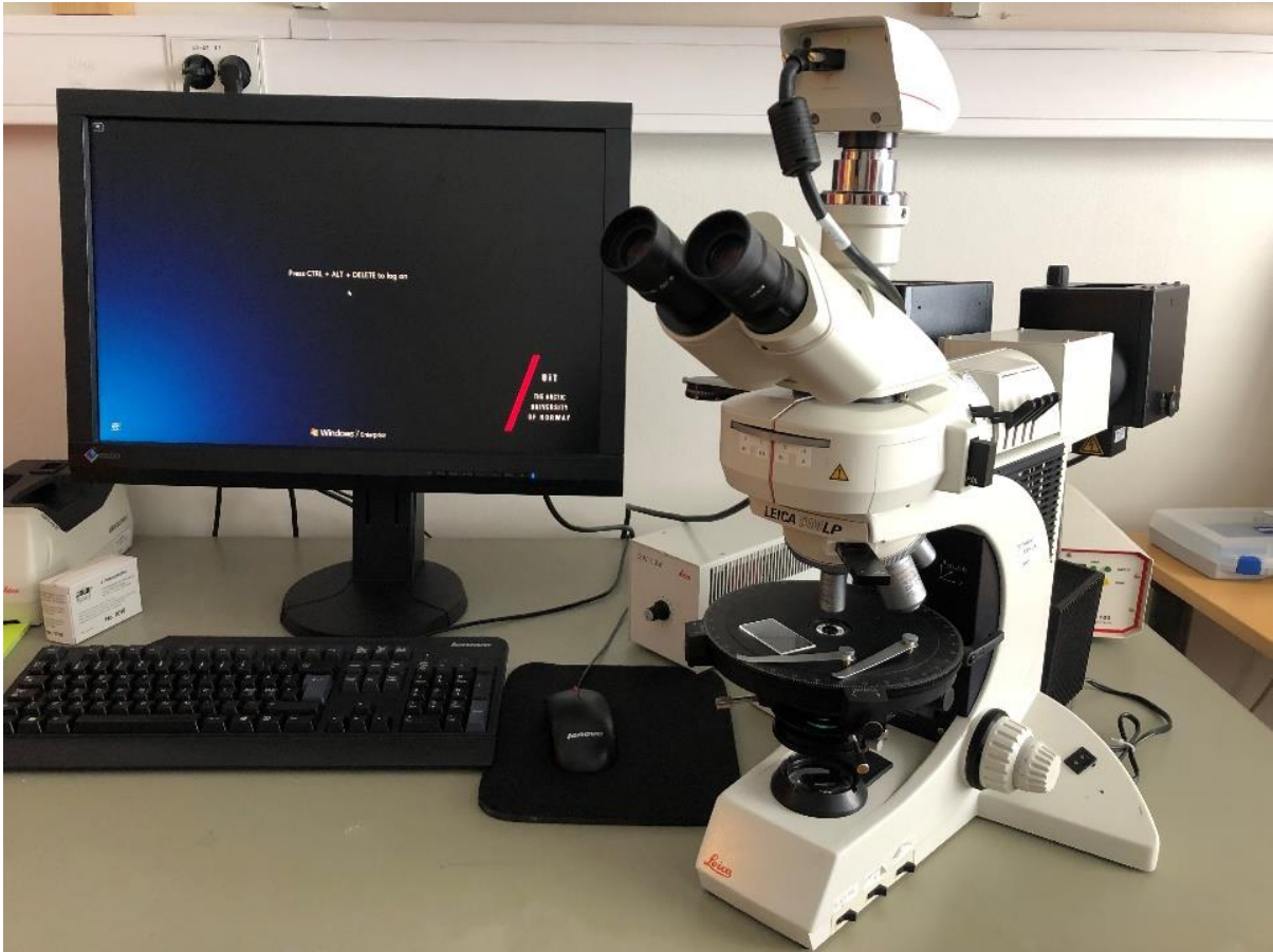
Slika 11. Mikroskop korišten za rudnu mikroskopiju.
