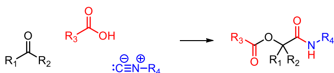
Shema 5. Nastajanje \alpha -aciloksi karboksiamida trokomponentnom Passerinijevom reakcijom.
